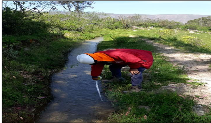
Fig. 12. Obtención de tirantes en el canal.
