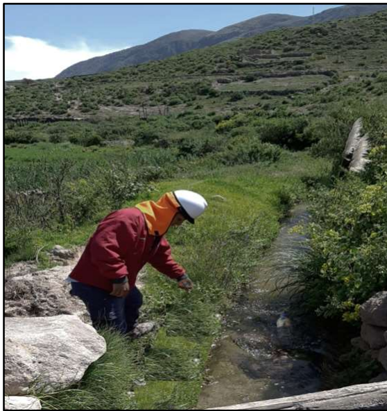
Fig. 11. Midiendo el tiempo de recorrido. Método del flotador
