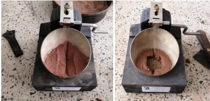
Figura 26: Ensayo de límite líquido por el método de Casagrande
