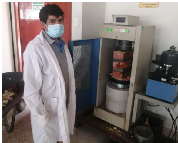
Figura 38: Ensayo de Compresión en Pilas R:80 A:20
