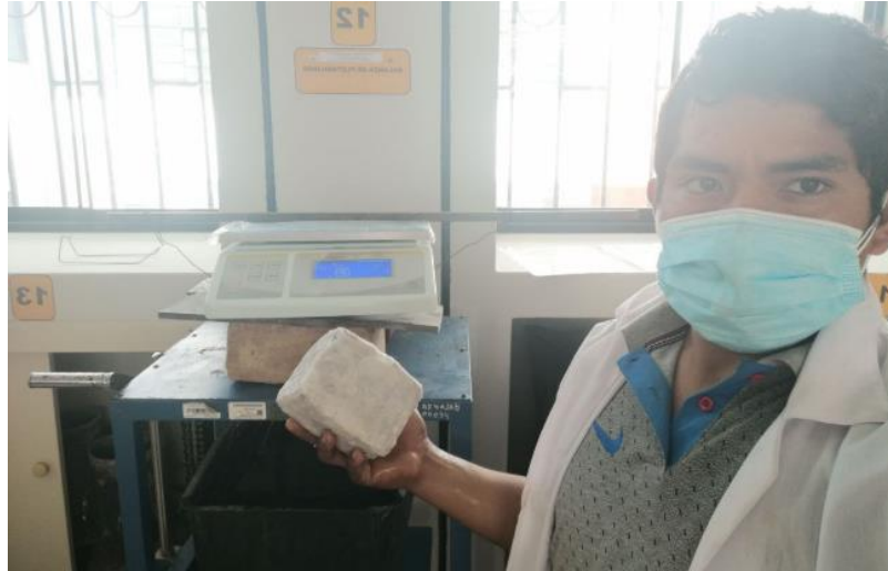
Figura 32: Calculo del volumen del bloque en la balanza de Flotabilidad
