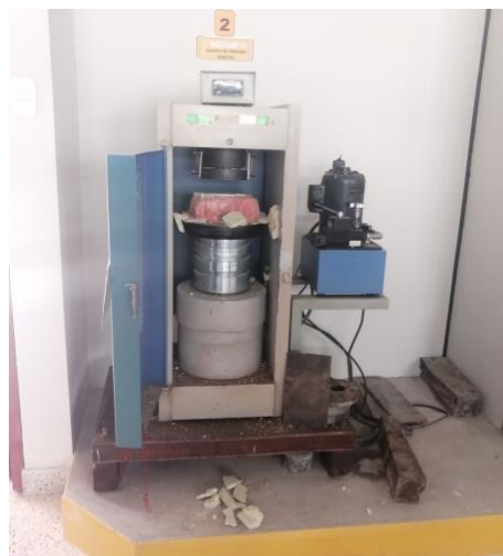
Figura 37: Rotura de Ladrillo Dosificación: R:60 A:40
