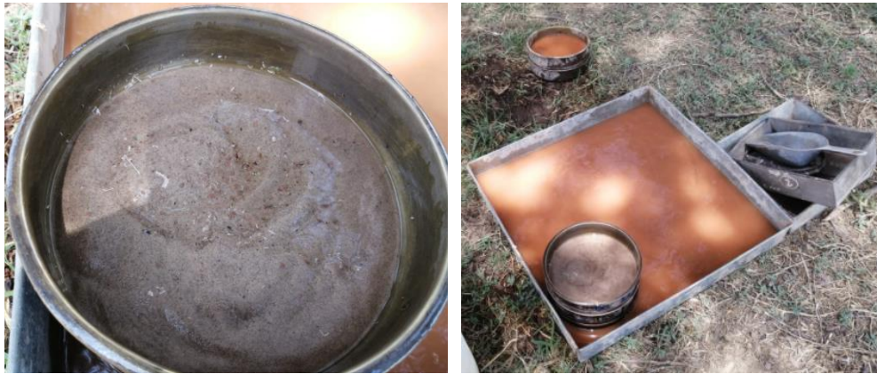
Figura 17: Método de lavado-granulometría.
