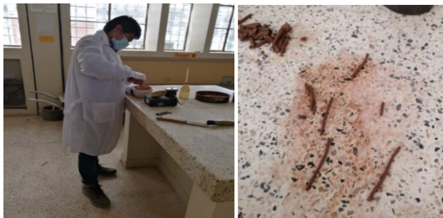
Figura 27: Determinación del límite líquido en laboratorio.
