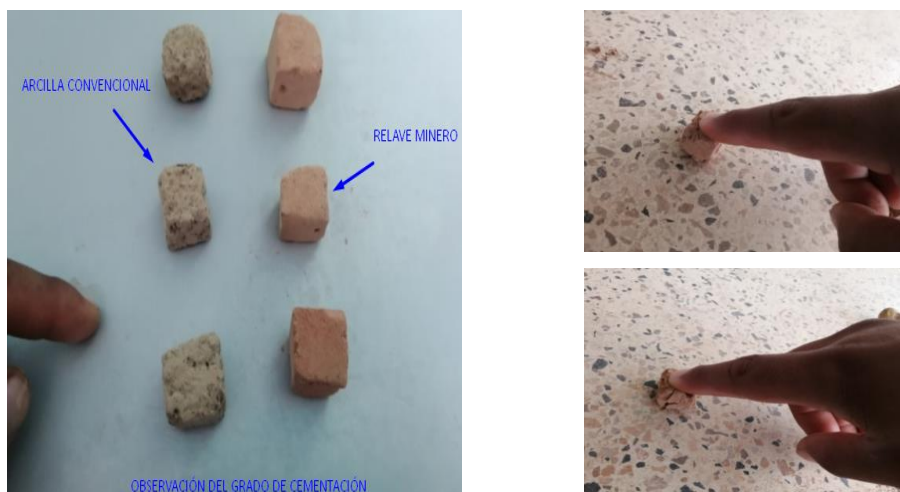
Figura 16: Observación del Grado de cementación
