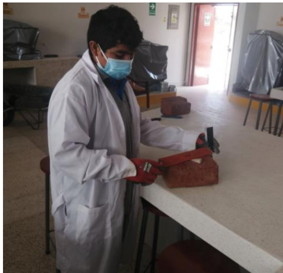
Figura 34: Ensayo de Alabeo de ladrillos
