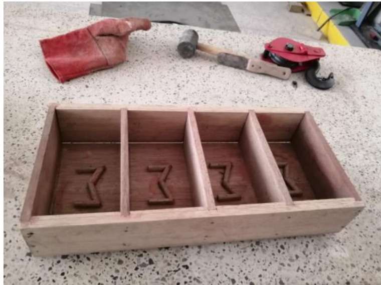
Figura 8: Molde o Gravera para la Elaboración de Ladrillos.
