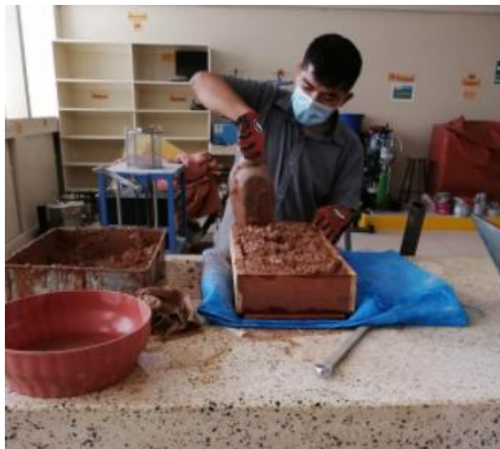
Figura 9: Elaboración de los ladrillos de Relave Minero
