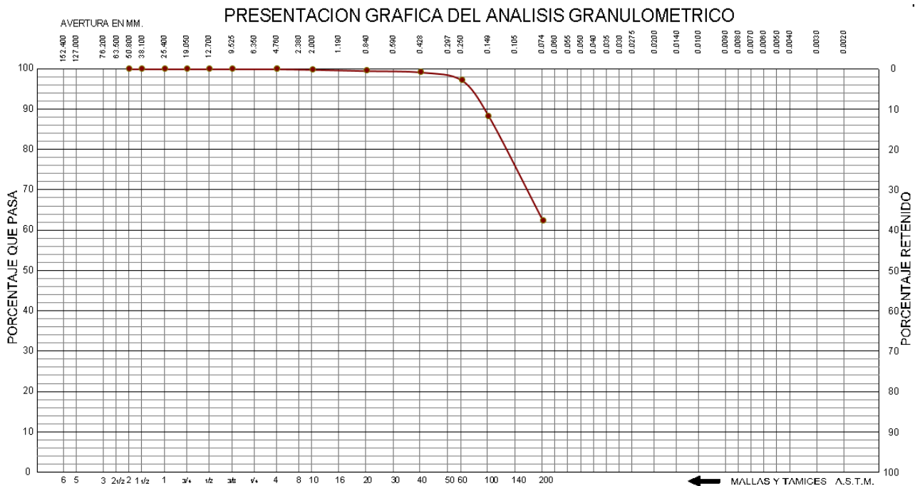
Figura 20: Análisis Granulométrico por Tamizado (M-02)
