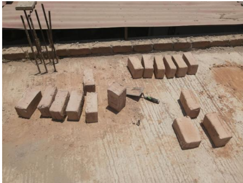
Figura 11: Secado de ladrillo elaborado con Relave.
