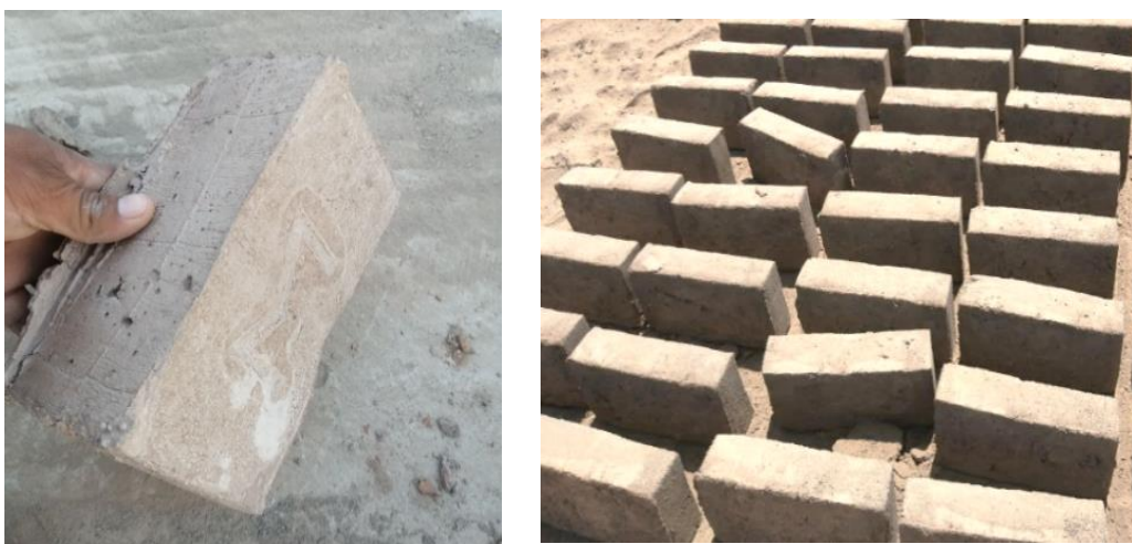
Figura 10: Secado a temperatura ambiente de ladrillo elaborado con Relave.
