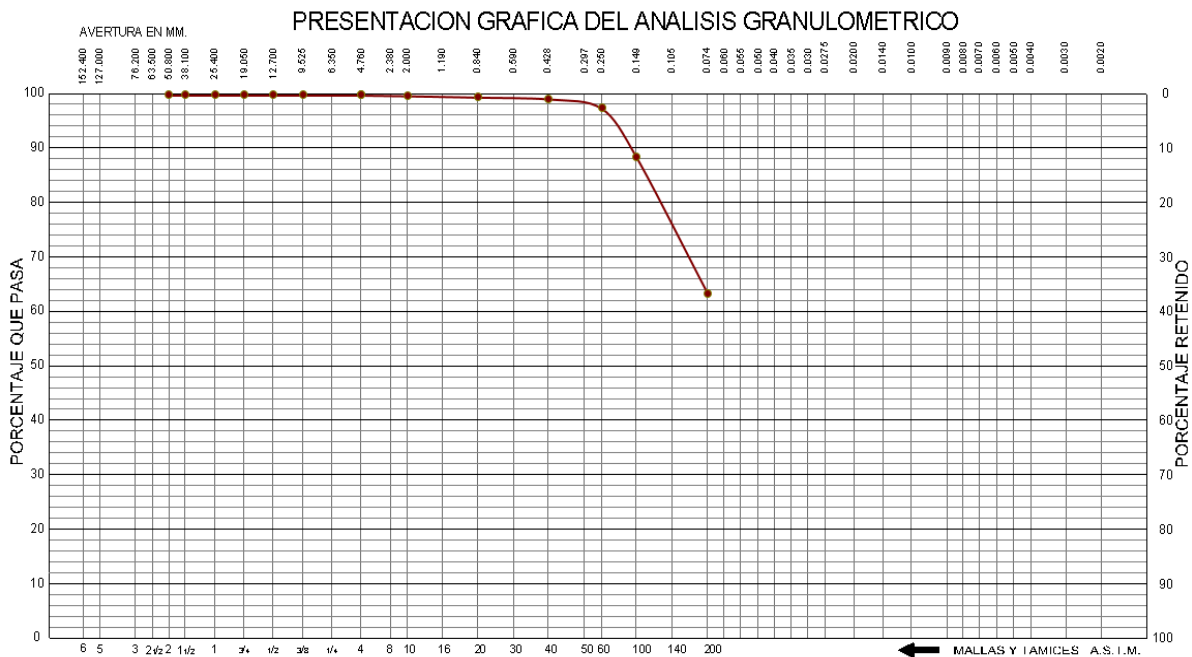
Figura 19: Análisis Granulométrico por Tamizado (M-01)
