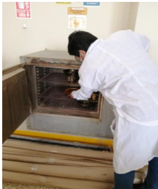
Figura 28: Secado en Horno
