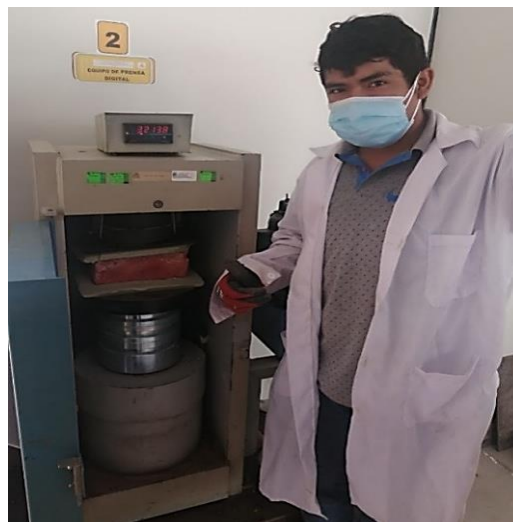
Figura 36: Rotura de Ladrillo Dosificación: R:70 A:30
