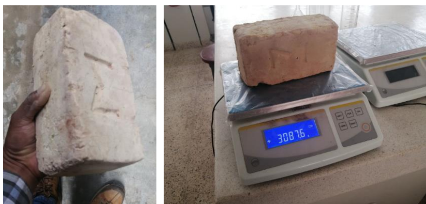
Figura 14: Ladrillo elaborado y quemado con Relave, Arena, Cemento y Cal.
