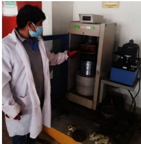
Figura 35: Rotura de Ladrillo Dosificación: R: 80 A: 20
