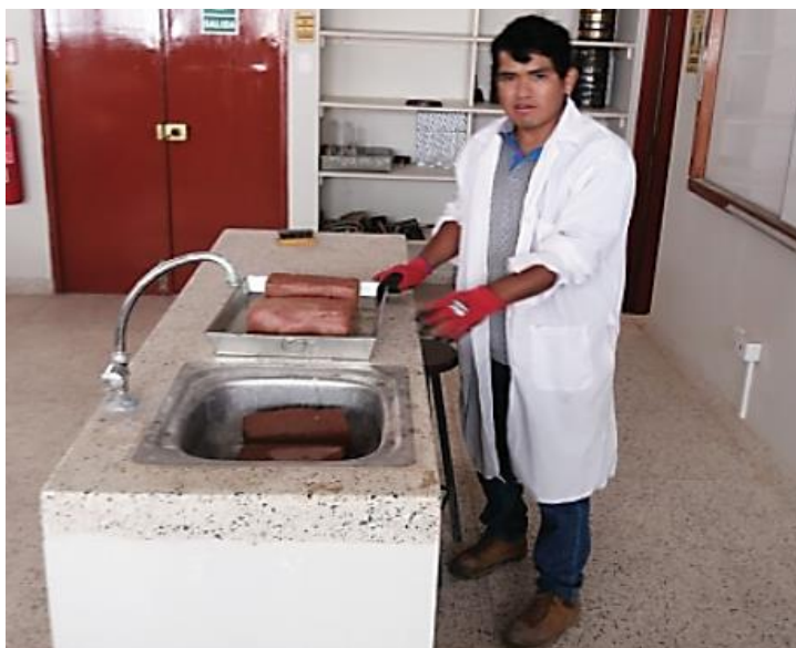
Figura 33: Ensayo de Succión de Ladrillos
