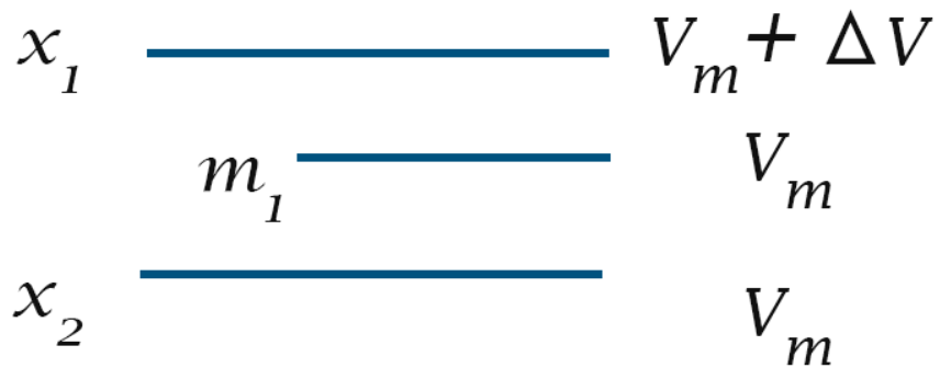
Figura N°52: Configuración de placas de lazo abierto para prueba de fuerza electrostática.
