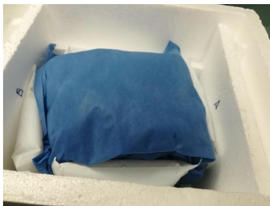
Foto 1. Posición de las planchas de Tecnopor y de los geles refrigerantes en la carga mínima de la caja N°11
