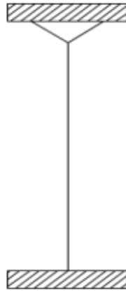
Fig. 39 Modelamiento unidimensional de la columna
