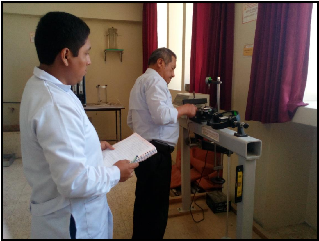
Fig. 85 Fotografía de ensayo de corte directo
