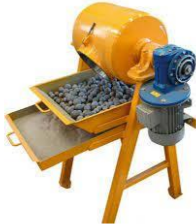
Figura 13. Molino de bolas de laboratorio.
