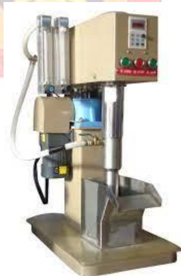
Figura 14. Celda de flotación Denver para uso en laboratorio.
