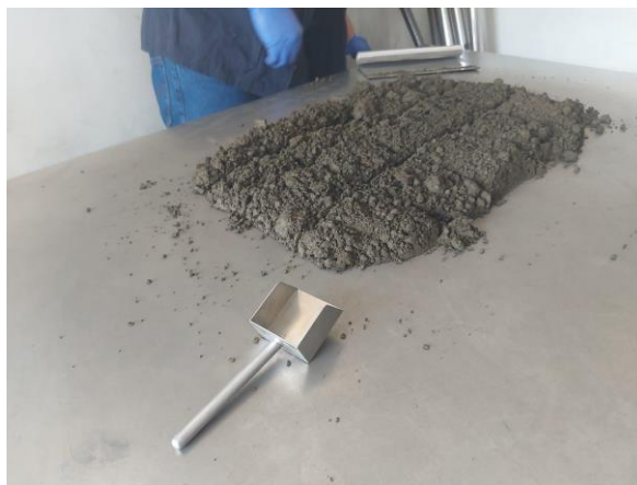
Fig, N°3 Toma de muestra para análisis de humedad y Químicos
