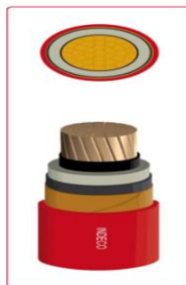
Figura 3 Cable Indeco 3x120mm 2 N2XSY 18/30 KV.
