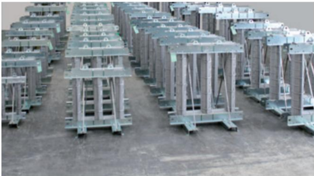
Figura 7 . Núcleo de Transformador Seco Encapsulado en Resina
