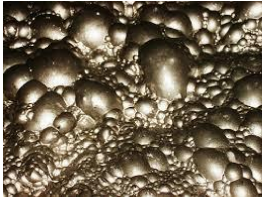
Fig. 2.6. Espuma de concentrado acumulado en la parte superior de la celda [4]
