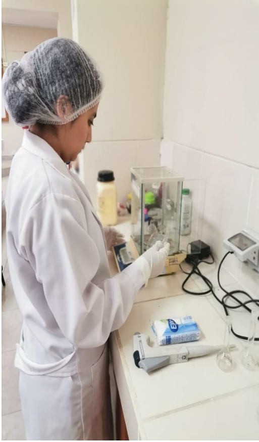
Determinación de la densidad del aceite esencial de Mentha x piperita
