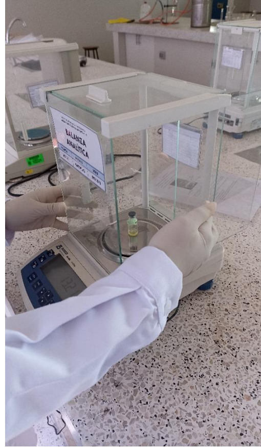
Determinación de la densidad del aceite esencial de Mentha x piperita
