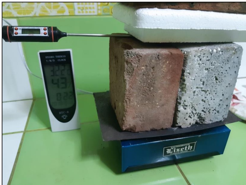
Imagen N° 24: Ensayo no normalizado de control de temperatura entre dos materiales de diferente procedencia.
