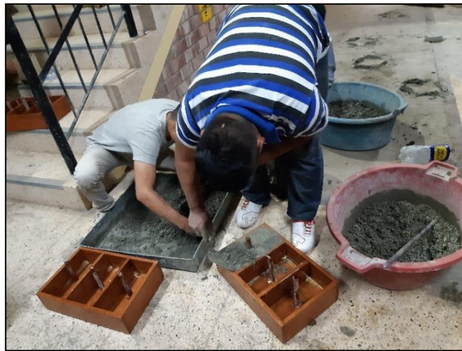
Fig. N° 12: Moldes de madera de 25x12.5x9 cm para ladrillos de concreto ligero
