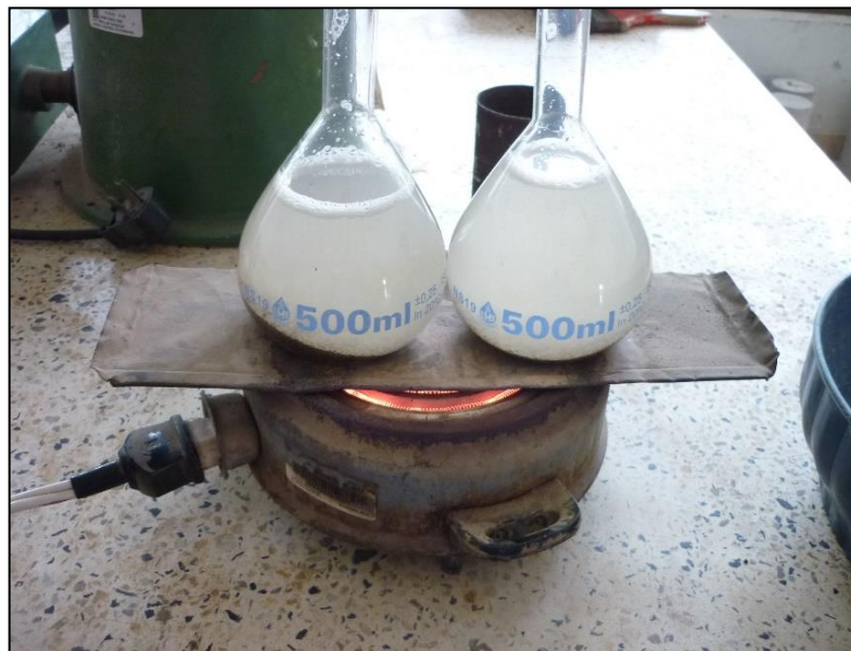
Imagen N° 4: Peso específico y grado de absorción de agregado fino.
