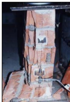
Fig. N° 8: Falla por trituración de pila.
