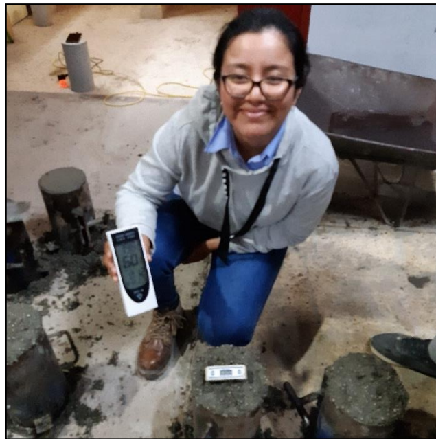
Imagen N° 10: Toma de temperatura del concreto y uso de termohigrómetro para lectura de temperatura ambiente y humedad relativa.
