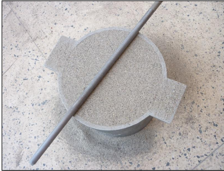
Imagen N° 1: Ensayo PUC, PUS de agregado fino.
