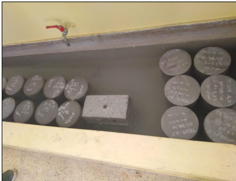
Imagen N° 16: Saturación de unidades de albañilería
