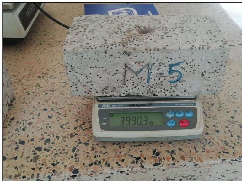
Imagen N° 20: Unidad luego de haber sido expuesta al horno por 24h. (Peso seco)
