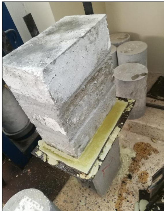
Imagen N° 18: Refrentado adherido utilizando azufre para pilas.
