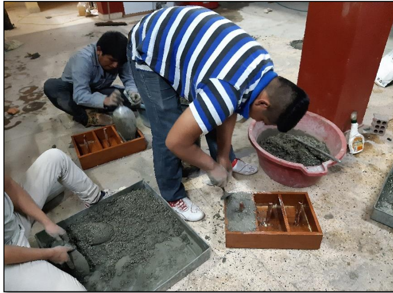
Imagen N° 15: Mezclado y llenado de unidades de albañilería.
