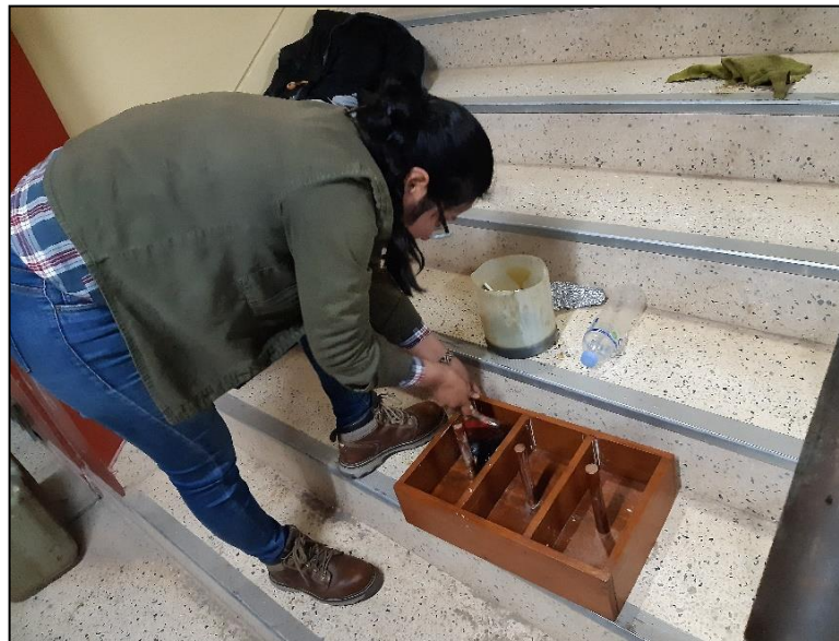
Imagen N° 14: Preparación de moldes para unidades de albañilería
