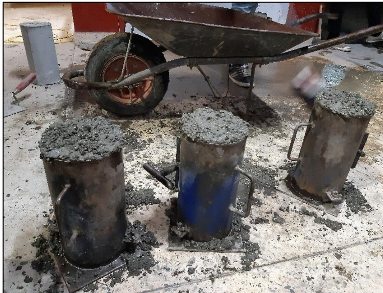
Imagen N° 8: Moldeado de testigos cilíndricos.
