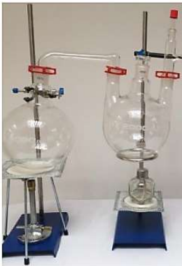
Fig.2.16. Equipo de laboratorio empleado en la adsorción de vapor de agua.[4]
