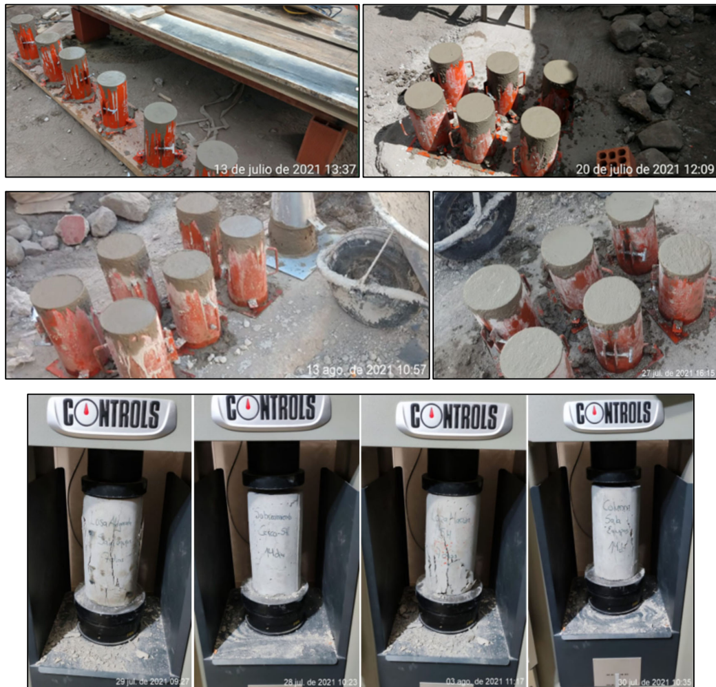
Fig. 110 Toma de testigos y ensayo de compresión en el laboratorio
