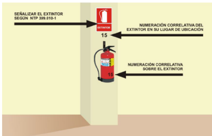
Fig. 48 Señalización del extintor
