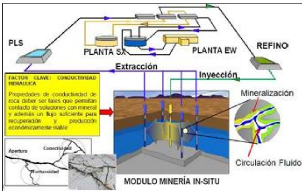
Figura 2. Esquema de un lugar donde se realiza la lixiviación in situ.
