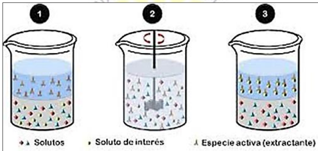
Figura 7. Esquema de principio de la lixiviación dinámica.
