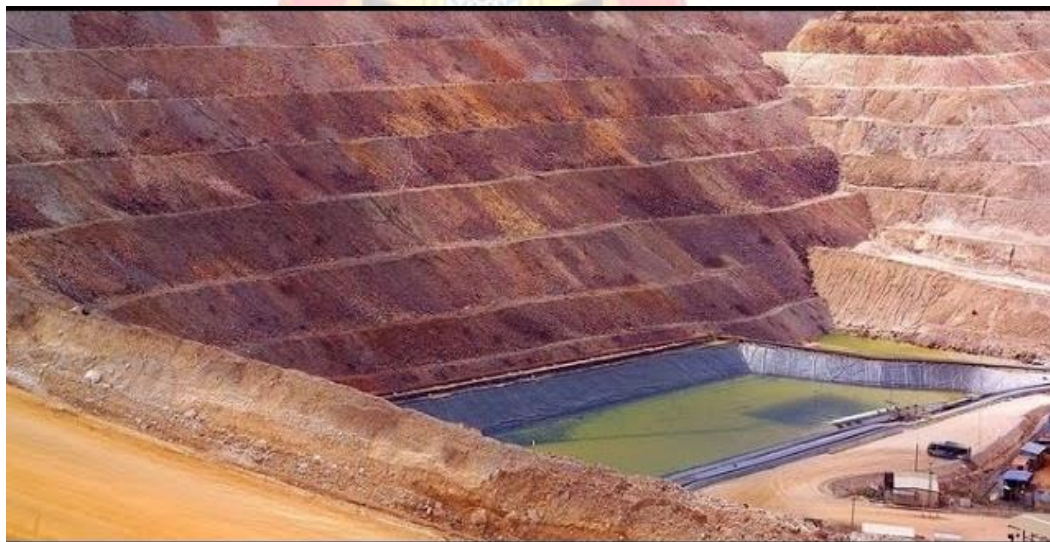
Figura 4. Vista de una lixiviación en pilas en la mina.
