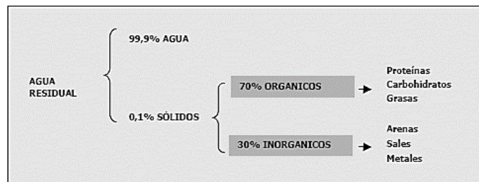
Figura 1. Composición típica de las aguas residuales
