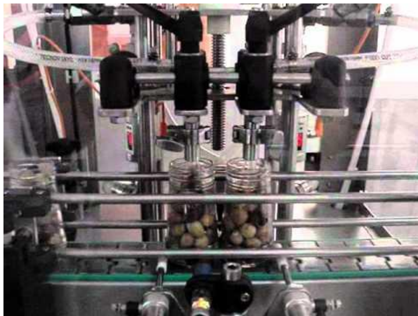
Fig. 4. Agregado de líquido de cobertura
