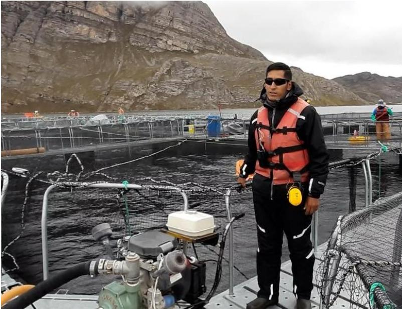
*Figura 27. Motobomba para el lavado de redes.*
