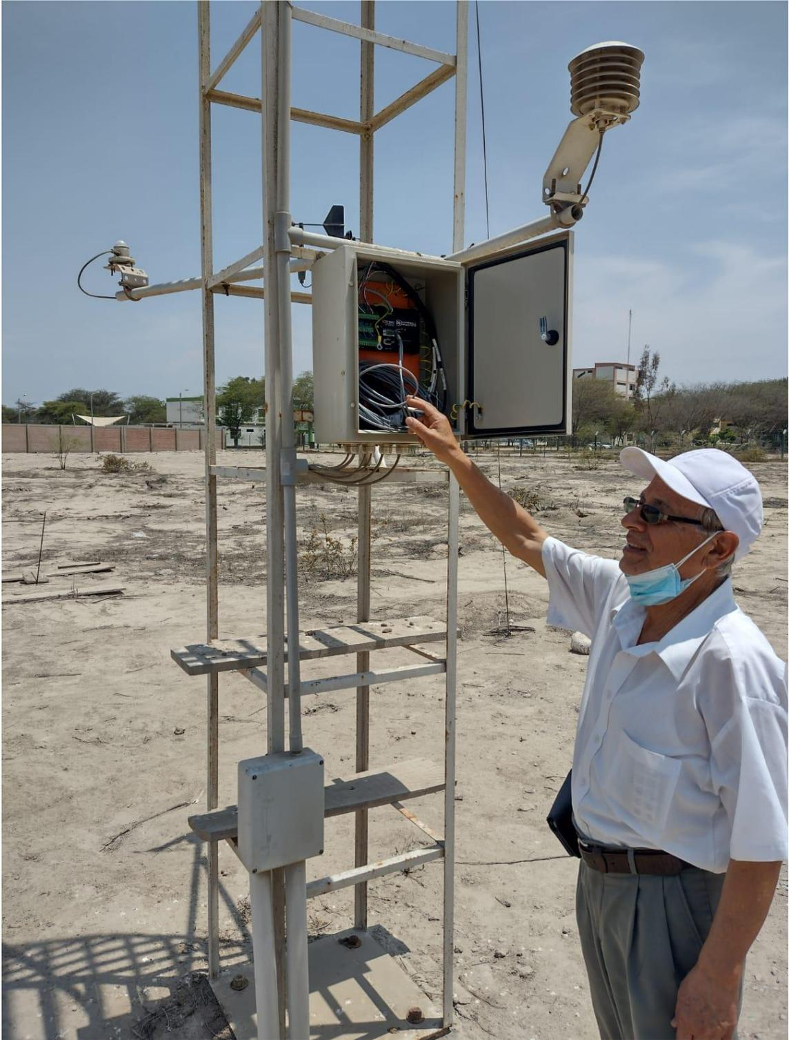
FOTO 8: VISTA DEL DATA LOGGER CONECTADO A LOS DIFERENTES SENSORES METEOROLÓGICOS.
