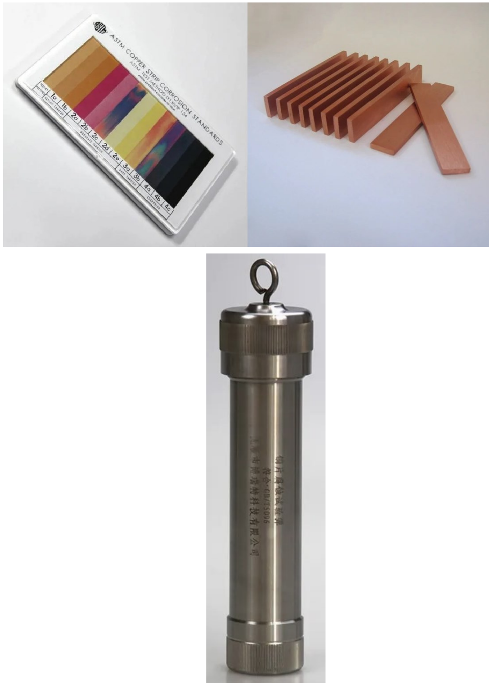
Figura 7. Carta de colores, láminas de cobre y recipiente a presión empleada en la determinación de corrosión.
