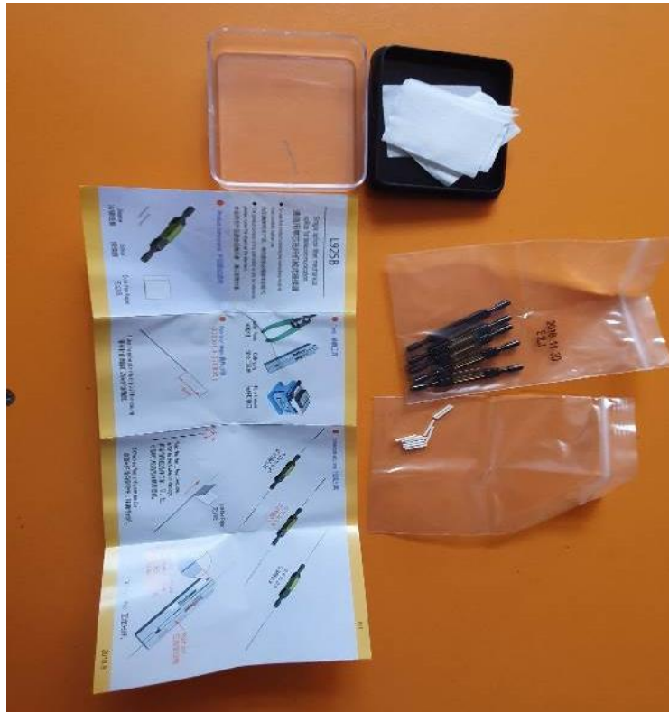
Fig. 12. EMPALMADOR MECANICO DE FIBRA 5 UNIDADES. No es más que la unión de los dos extremos de las fibras en un soporte mecánico
