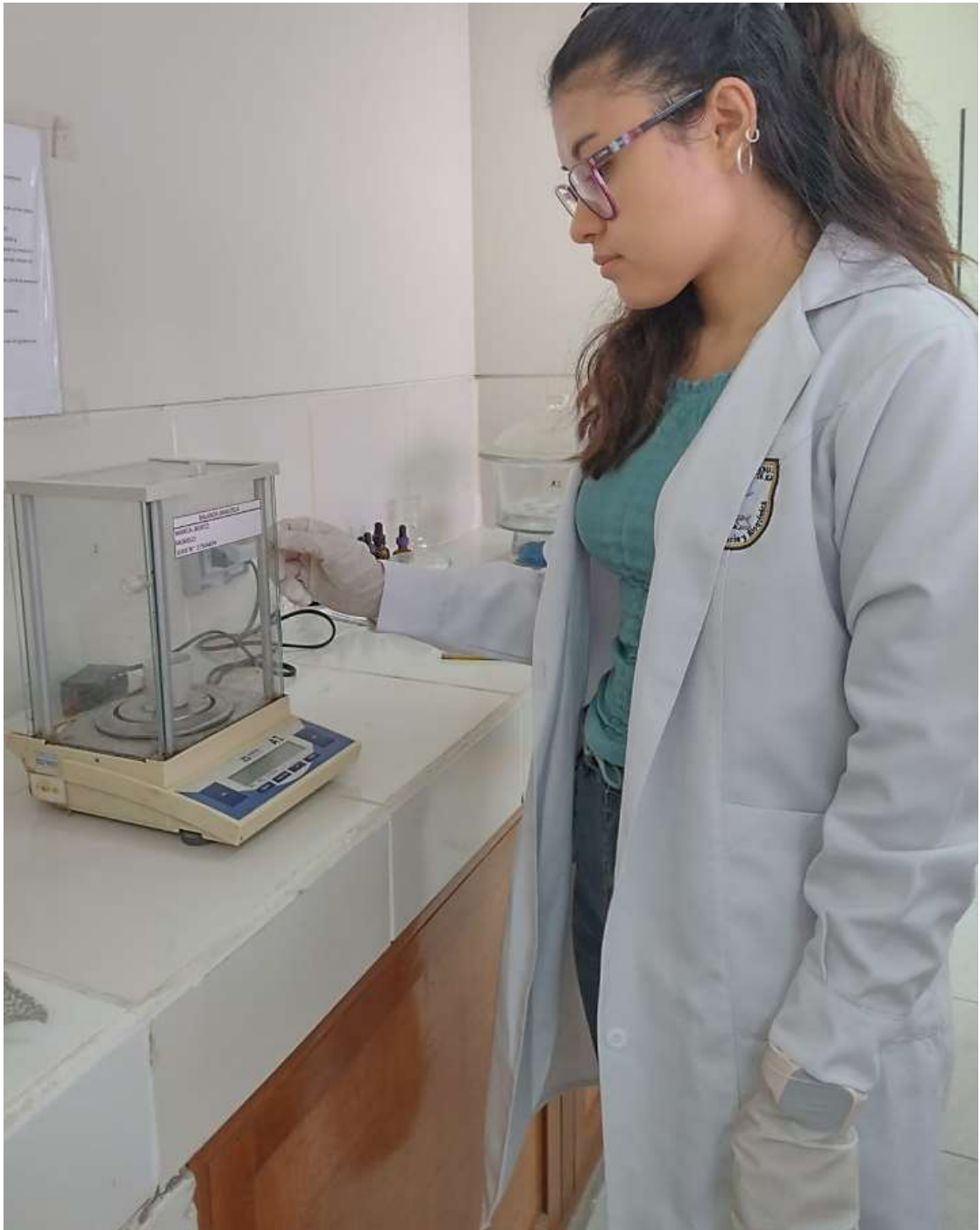
Figura 27. Pesado de las cenizas de cada muestra, en la balanza analítica (previa calibración de los crisoles).
