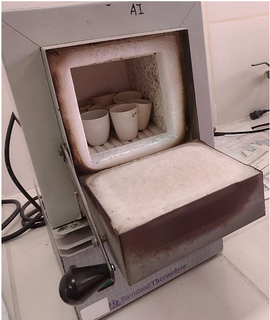
Figura 23. Grupo de muestras en la mufla, para la determinación de cenizas.
