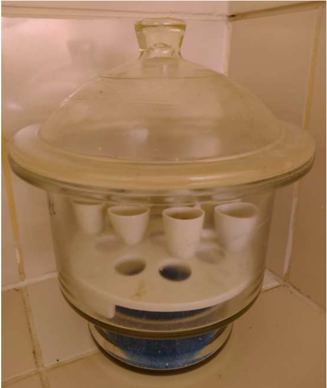
Figura 26. Muestras colocadas en el desecador de vacío (de vidrio).
