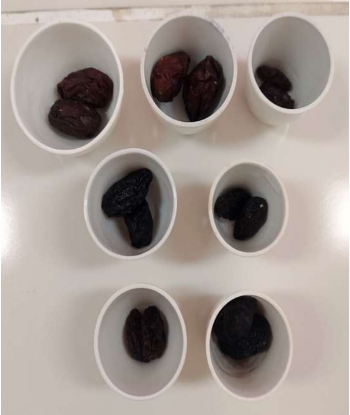
Figura 21. Colocación de las muestras en los crisoles rotulados en la base respectivamente.
