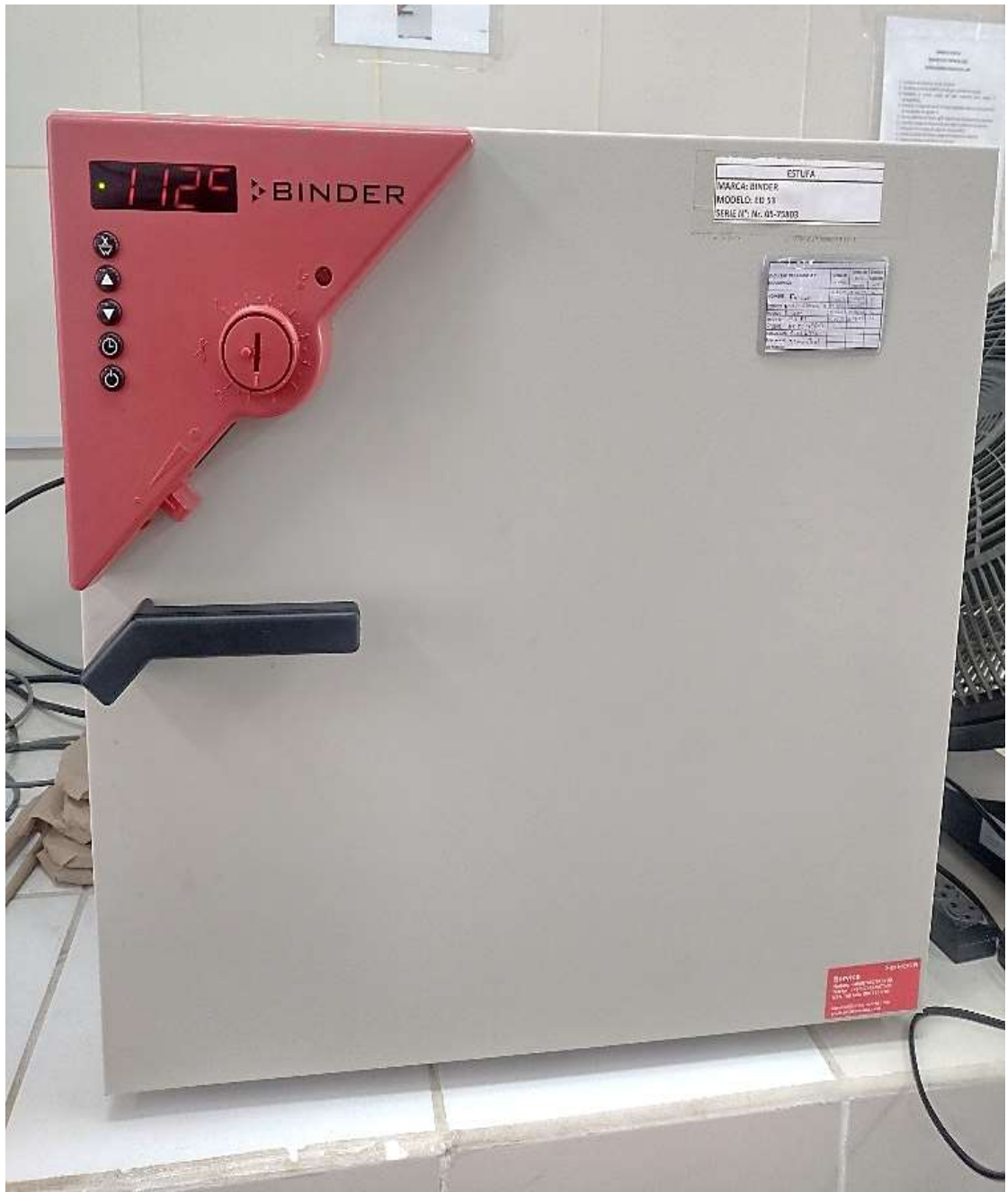
Figura 19. Estufa de laboratorio, marca: Binder, en proceso de deshidratación de las muestras.
