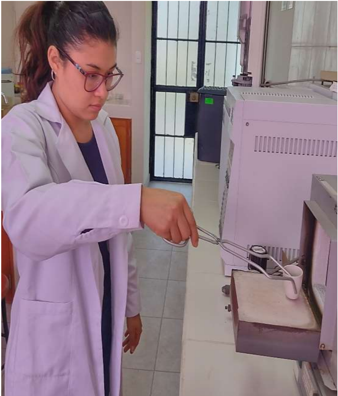
Figura 22. Distribución de los crisoles (con las muestras), en la mufla.
