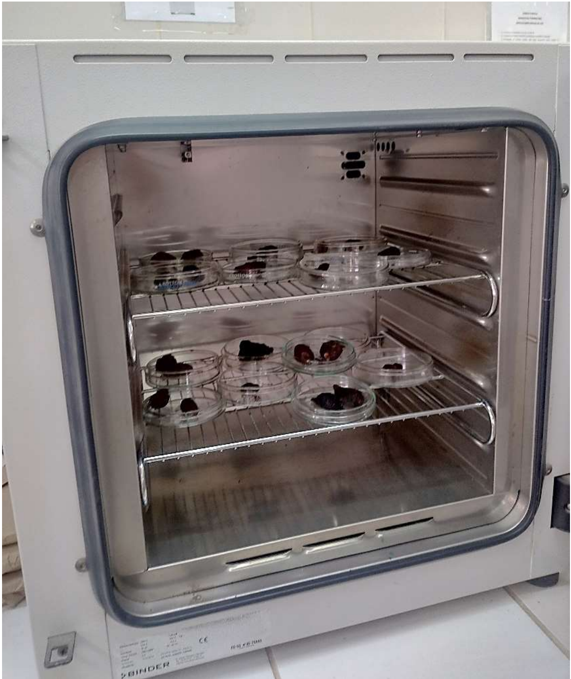
Figura 20. Grupo de muestras en la estufa, previas a la determinación de cenizas, actividad de agua y humedad.
