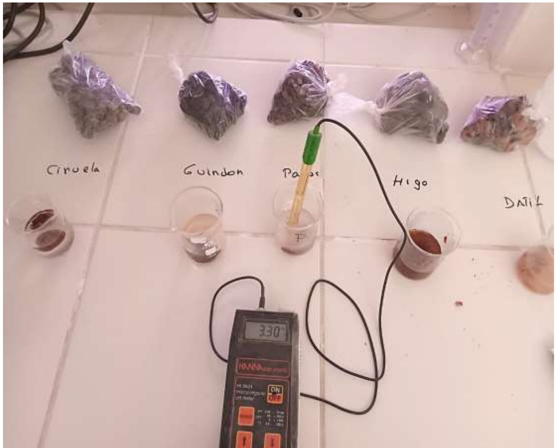
Figura 29. Determinación de pH de cada muestra, mediante el pH-metro.
