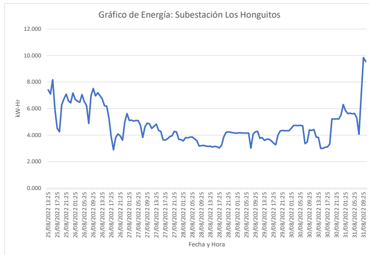
Fig. 1. Consumo de energía eléctrica; Subestación de los Honguitos/ ATRIA. Fuente: Elaboración propia. Lecturas importantes registradas:
