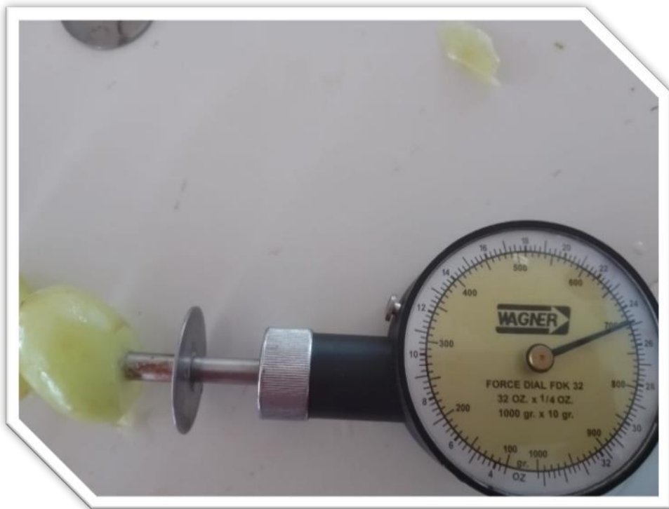
Fig. 7: Prueba del Penetrometro
