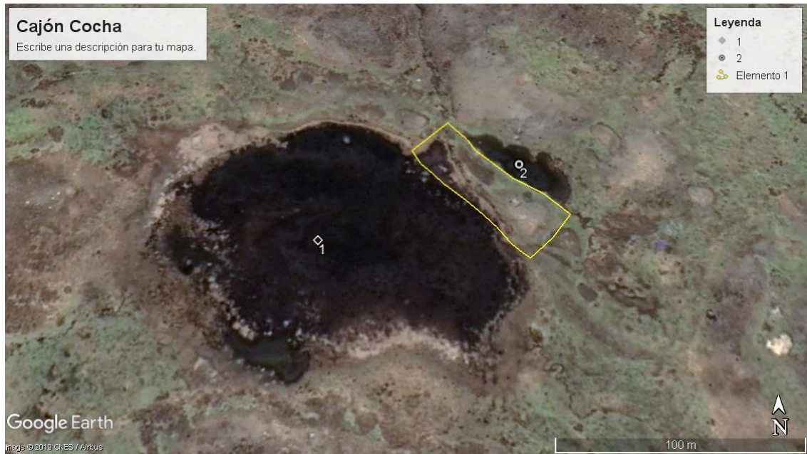
Lámina 12: 1) Represa tipo cocha, 2) ojo de agua por filtración y 3) el dique (delimitado por el polígono amarillo). Fuente: Franclyn Jayo; 2022
