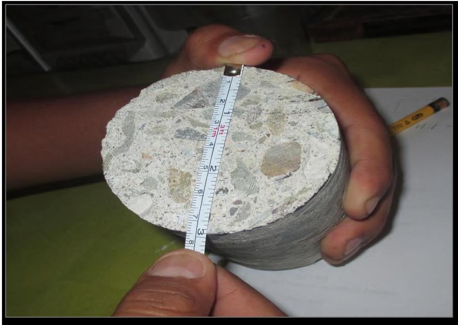
Figura 08: Verificación del diámetro para el cálculo de la sección transversal del núcleo
