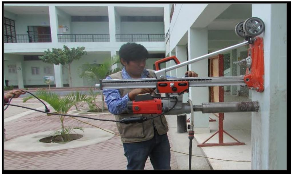
Figura 06: Perforación del elemento estructural para extracción del núcleo
