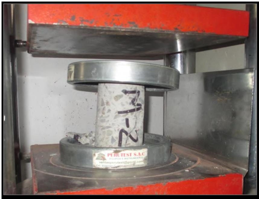
Figura 11: Ensayos de núcleos de diamantina
