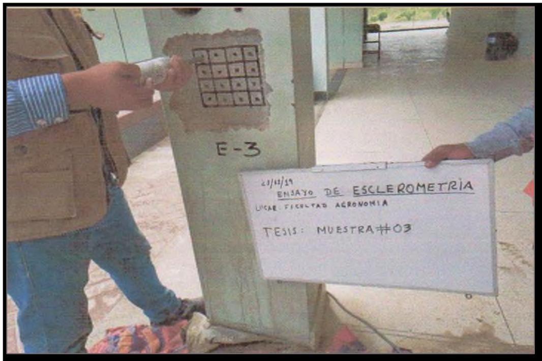
Figura 18: Ensayo de esclerometria N°03
