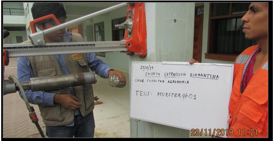
Figura 07: Extracción del núcleo en el elemento estructural
