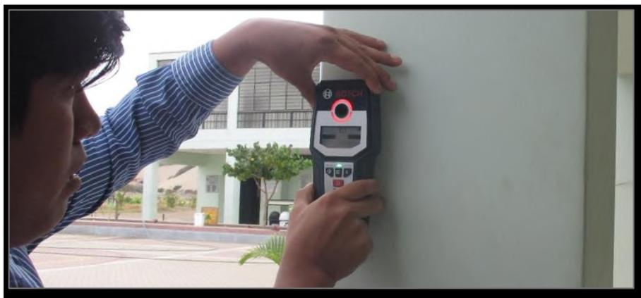
Figura 04: Escaneo de barras de refuerzo
