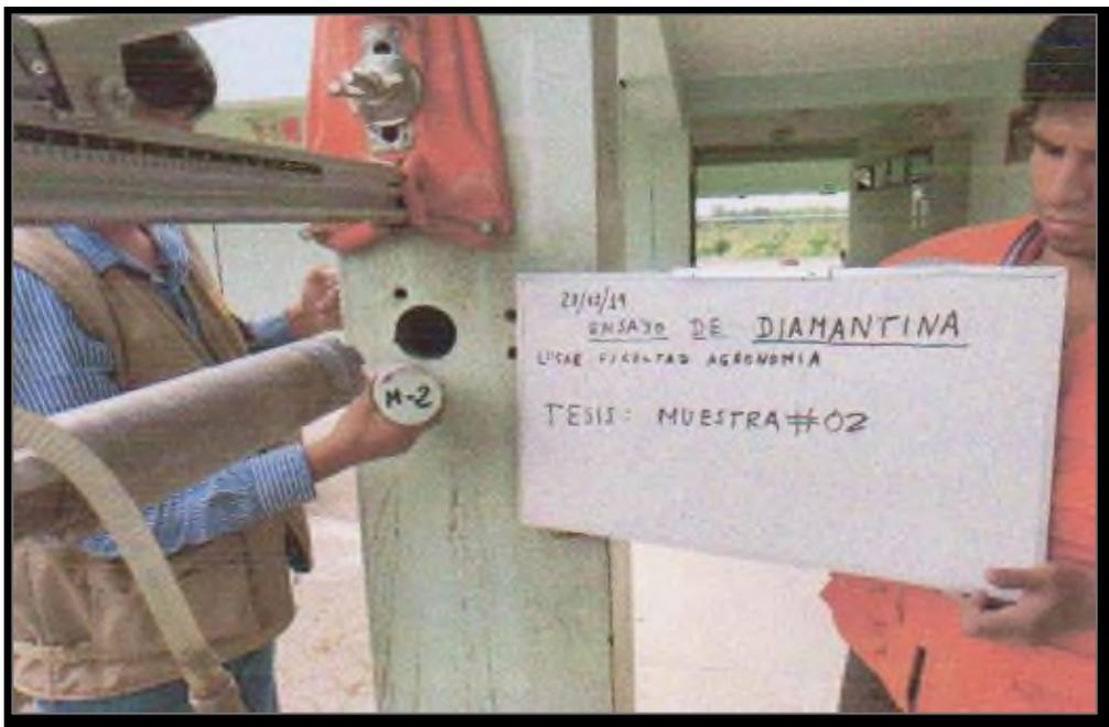
Figura 10: Extracción del núcleo M-2
