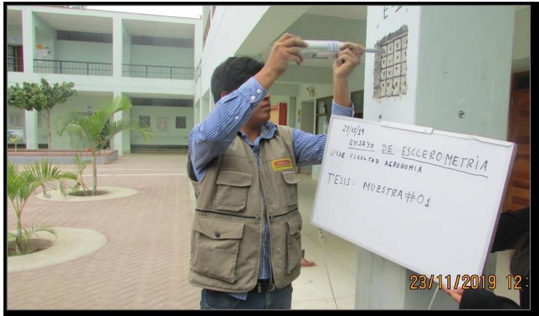
Figura 14: Lectura del ensayo de esclerometria
