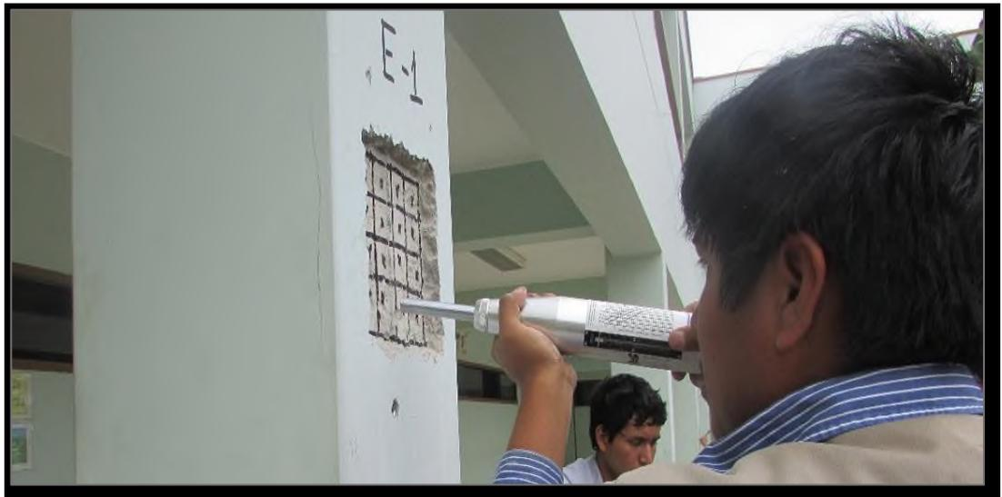
Figura 15: Lecturas del ensayo de esclerometria en cada cuadrícula
