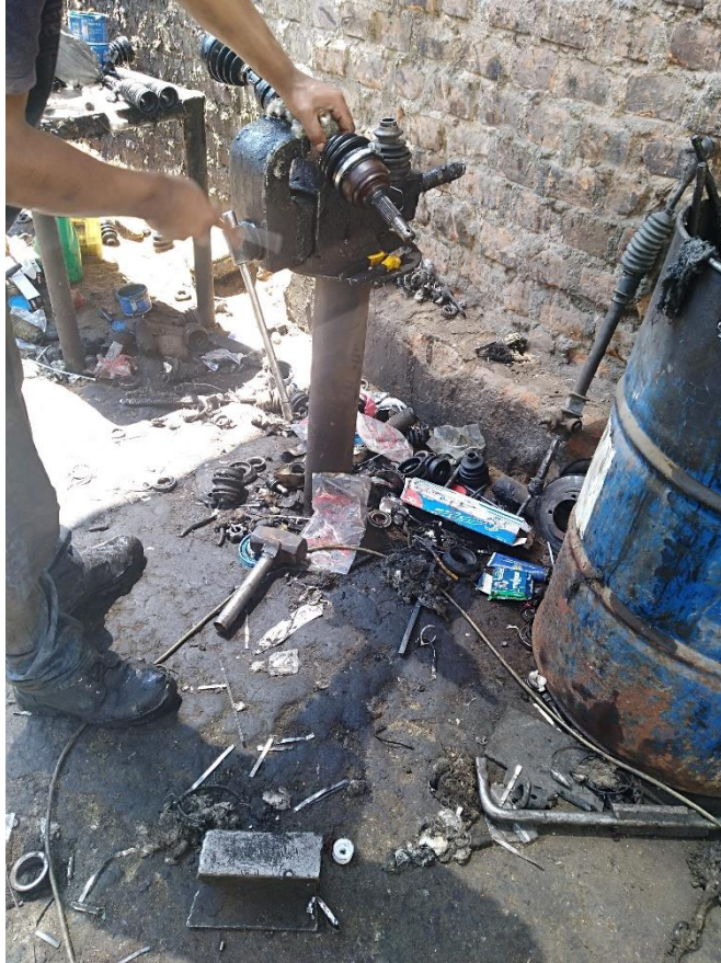
LOS OPERARIOS NO TIENEN EQUIPOS DE PROTECCIÓN PERSONAL
