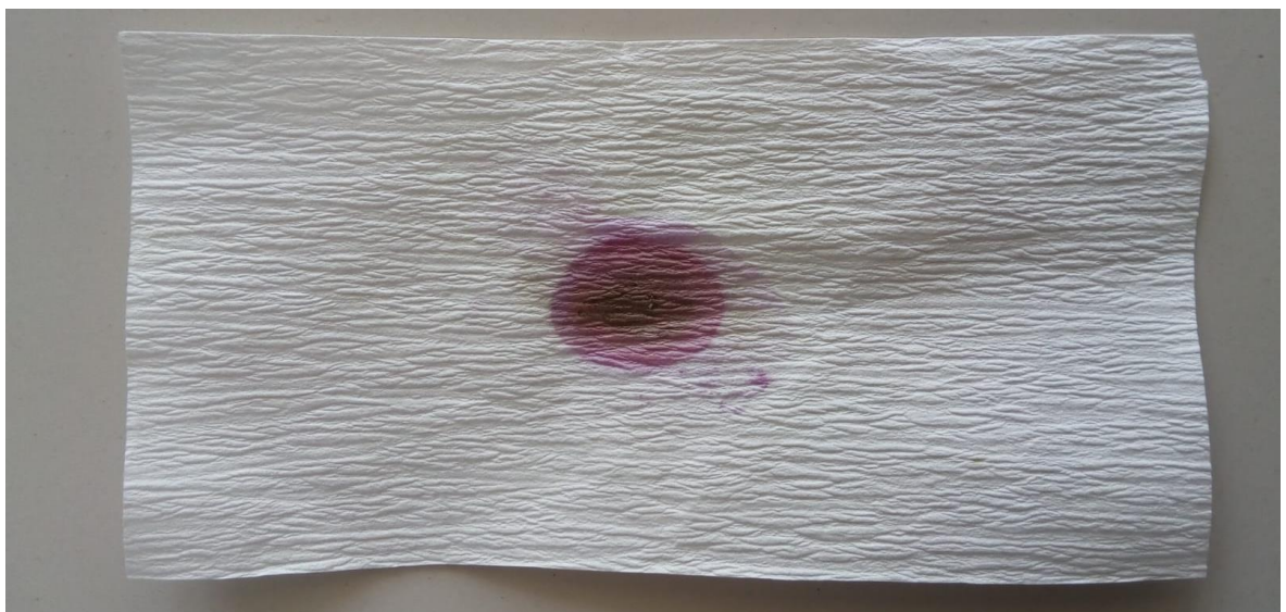
Figura 14 Reacción de ninhidrina para detección de aminoácidos.
