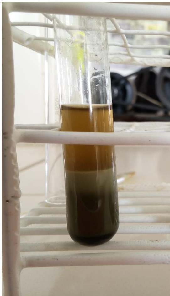
Figura 16 Reacción de Liebermann, Burchard para detección de triterpenos y/o esteroides.
