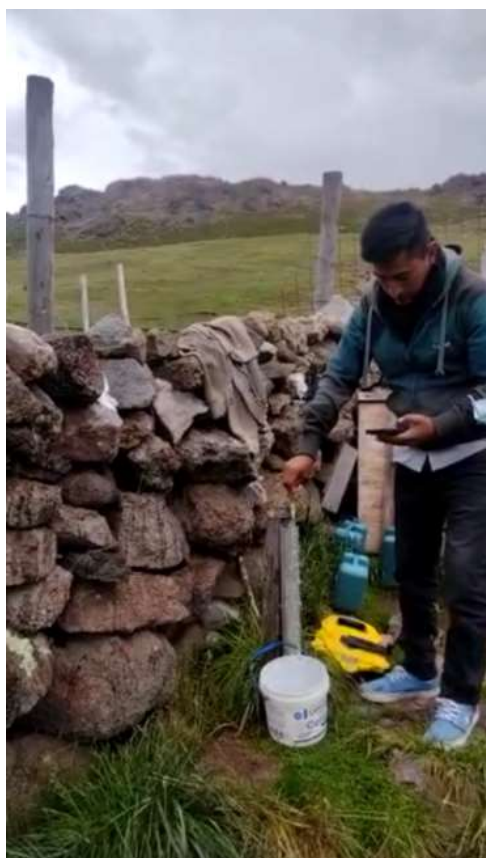
Fig. 9: Aforo de caudal en la red de agua potable
