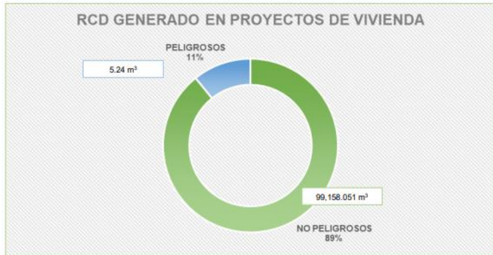
Fig. 4.: Cantidad de desechos sólidos de edificación y derribamiento producidos en planes de vivienda sin necesidad de un IGA, según nivel de peligro.
