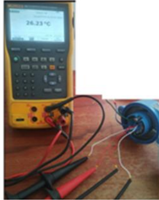
FIG. 7 medición de RTD con calibrador Fluke 754
