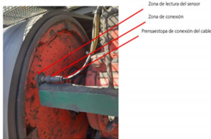
FIG. 1 Zonas de mantenimiento del sensor inductivo
