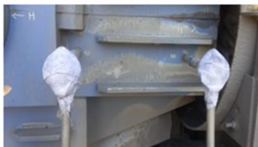
FIG. 2 colocación de papel seda en termopares
