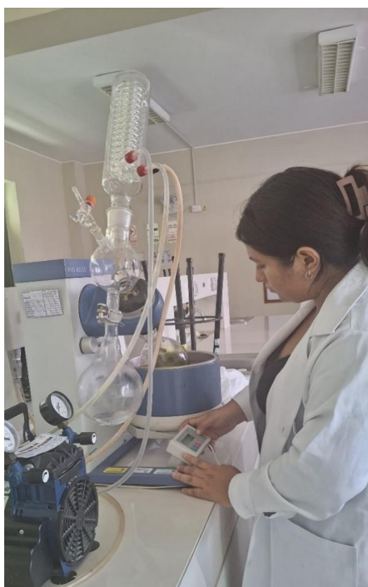
Figura 45. Proceso de separación de etanol 96° con uso del rotavapor
