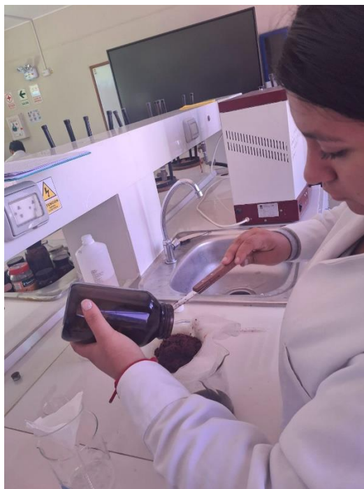
Figura 30. Filtración del extracto con gasa después de 15 días de maceración
