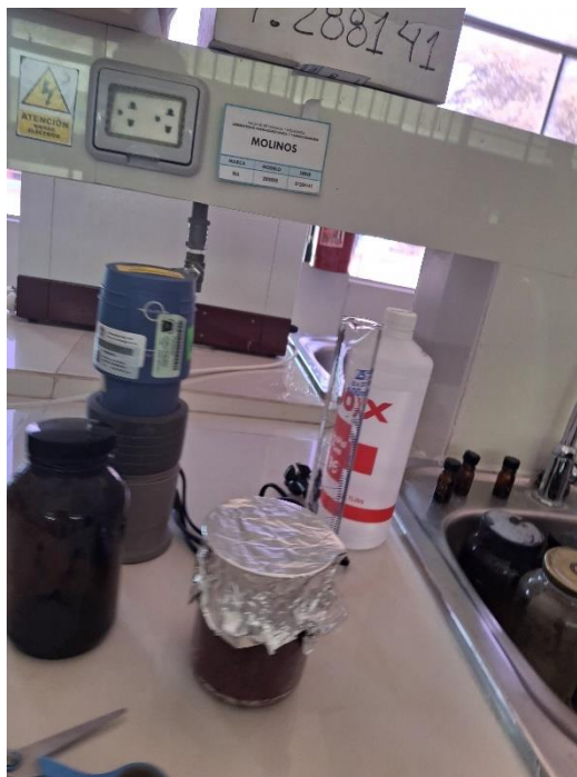
Figura 29. Maceración en frasco ámbar de la muestra molida con etanol de 96°
