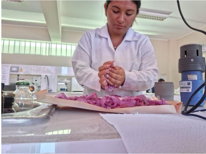
Figura 22. Muestra seca triturada de forma manual para reducir volumen
