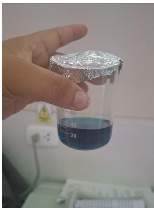
Figura 55. Reactivo ABTS activado con el persulfato de potasio
