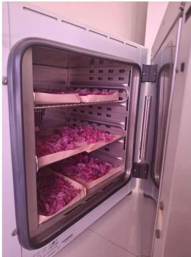
Figura 21. Uso de la estufa para la secada de la muestra
