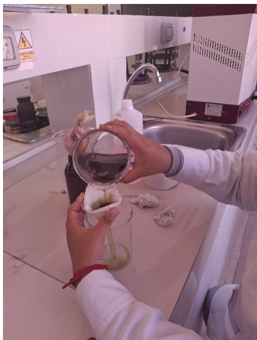
Figura 31. Filtración con papel filtro para obtener el extracto concentrado
