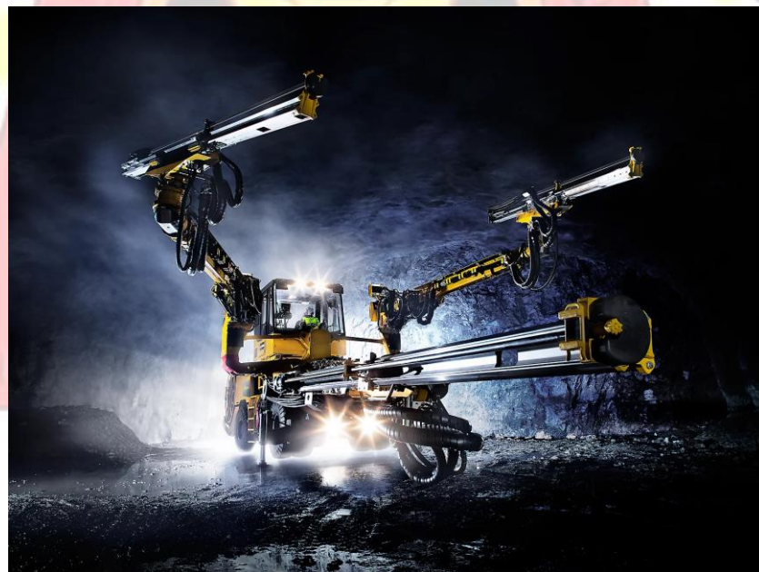
Figura 5. Equipo Jumbo Epiroc T1 operación
