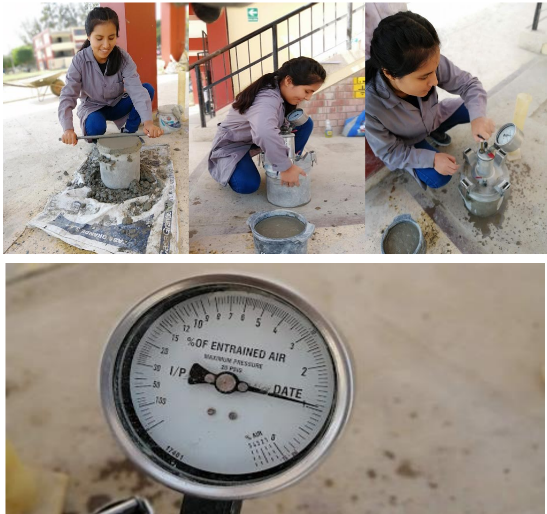
Ilustración 14. Ensayo de Peso Unitario y Porcentaje de vacíos del Concreto.
