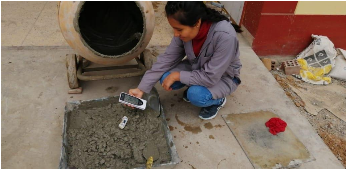
Ilustración 12. Control de Temperatura del Concreto elaborado.
