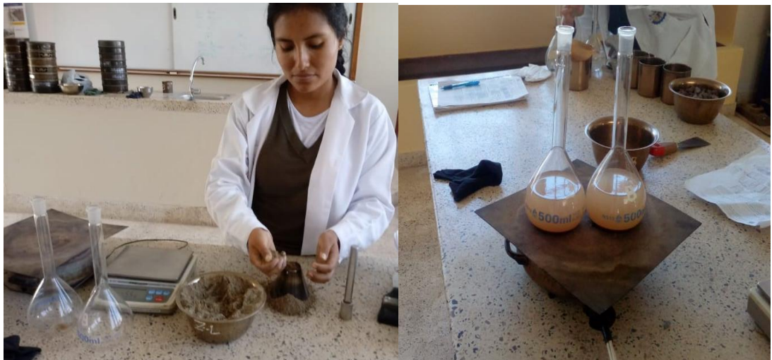
Ilustración 6. Ensayo de PH del cemento.
