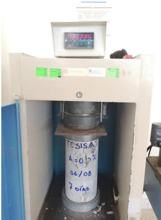
Ilustración 16. Ensayo de Rotura de Probetas – Concreto con Aditivo al 0.3%.
