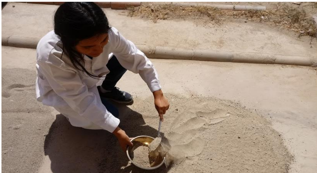
Ilustración 3. Ensayo de Granulometría – Agregado Fino
