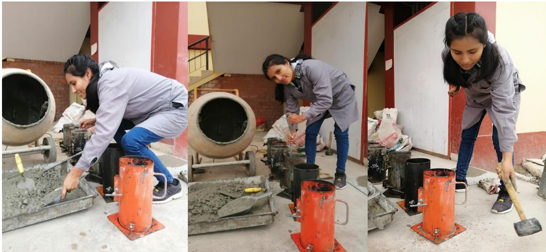
Ilustración 14. Ensayo de Peso Unitario y Porcentaje de vacíos del Concreto.
