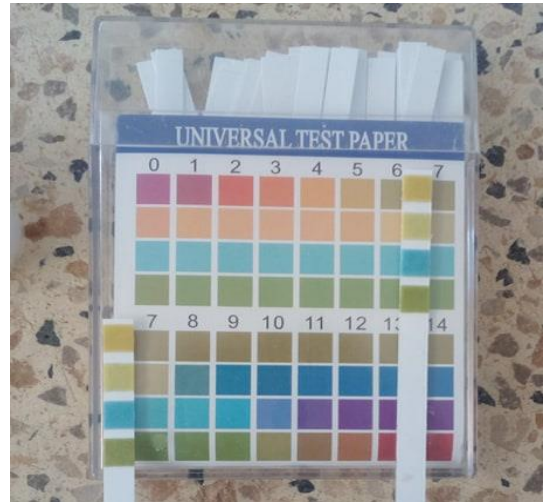
Ilustración 7. Ensayo de PH del Agua de diseño de mezcla.
