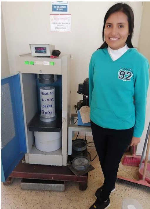
Ilustración 16. Ensayo de Rotura de Probetas – Concreto con Aditivo al 0.3%.
