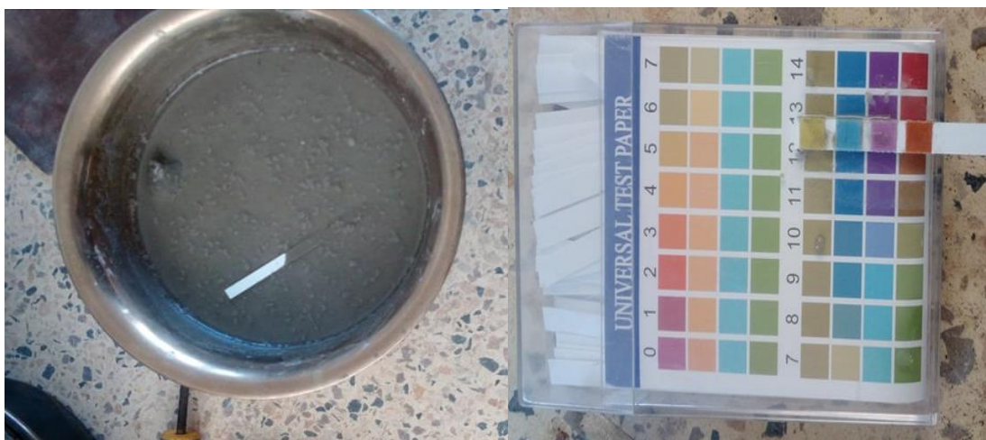
Ilustración 6. Ensayo de PH del cemento.
