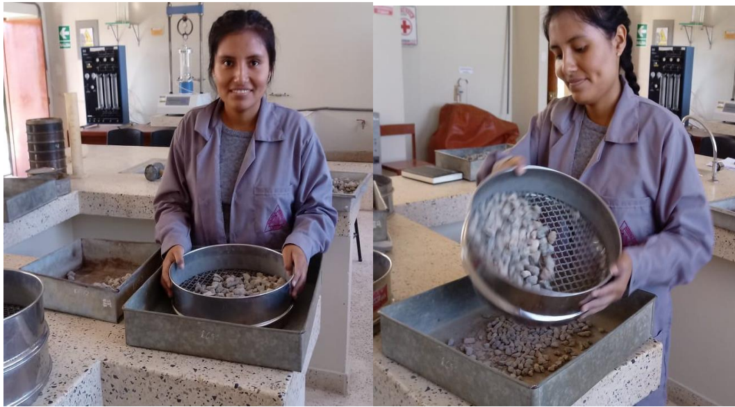
Ilustración 3. Ensayo de Granulometría – Agregado Fino
