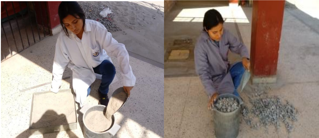
Ilustración 5. Ensayo de Peso Específico del Agregado Fino.
