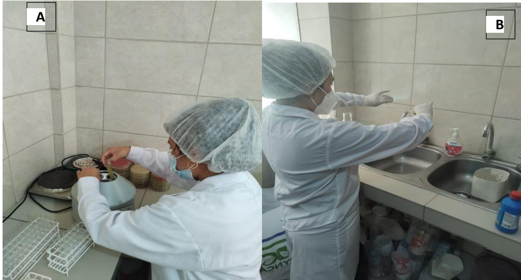
Figura 5: A) Centrifugando a 2 500 rpm x 10 minutos, B) Decantando el sobrenadante de las muestras centrifugadas.
