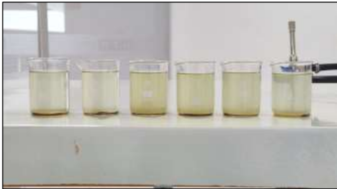
Figura 18. Etapa de la sedimentación de las muestras
