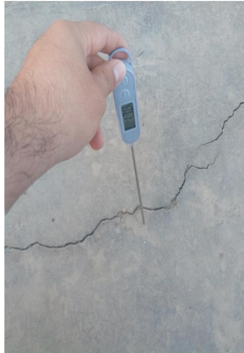
Figura 72 Registro de temperatura de la vereda (17.8°C) a una temperatura ambiental de 15°C.
