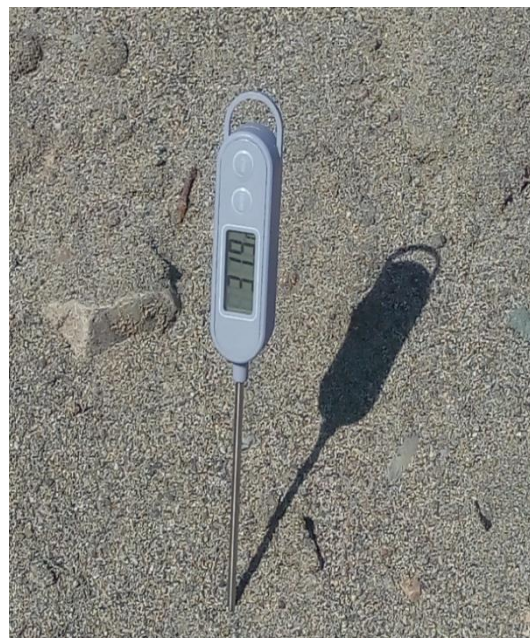
Figura 51 El agregado fino alcanza una temperatura de 31.9°C a una temperatura ambiental promedio alta (30°C)
