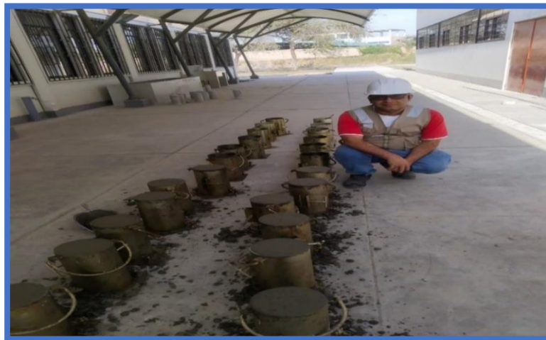
Figura 10 Realización de muestras de concreto a una temperatura promedio ( 22^{\circ}\text{C} ) en horario de 8:00 a.m.
