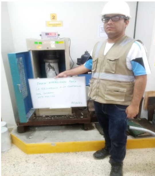
Figura 69 Probetas de concreto elaborados a temperatura ambiental promedio alta (30°C)
