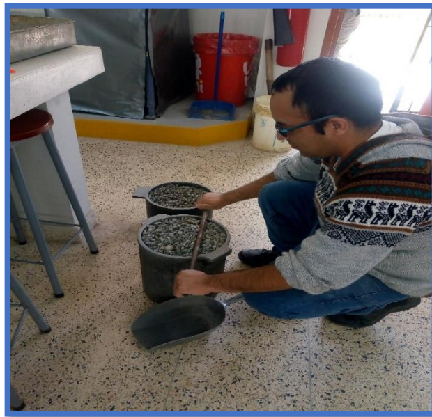
Figura 23 Realización del Ensayo de la Masa por unidad del agregado grueso
