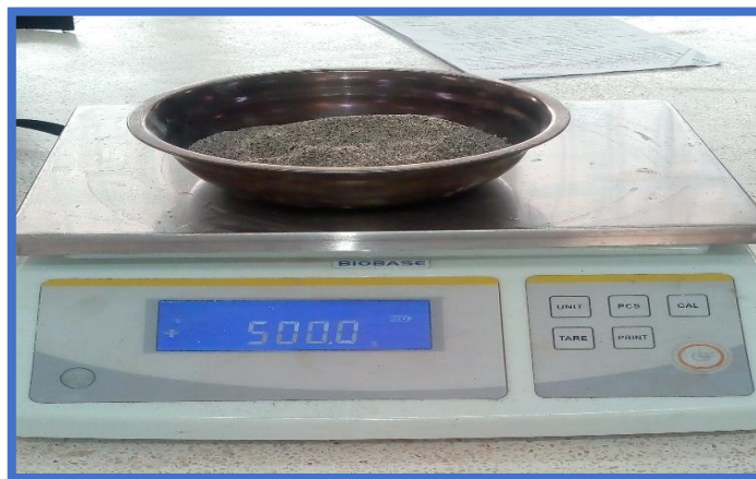
Figura 20 Peso del material en su humedad natural, para luego secarlo en el horno.
