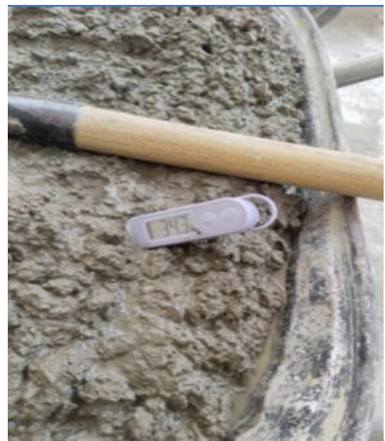
Figura 52 El concreto fresco alcanza una temperatura interna de 34.3°C a una temperatura ambiental promedio alta (30°C)
