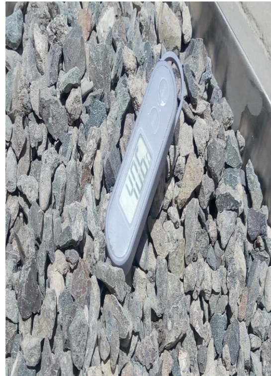
Figura 50 El agregado grueso alcanza una temperatura de 40.6°C a una temperatura ambiental promedio alta (30°C)
