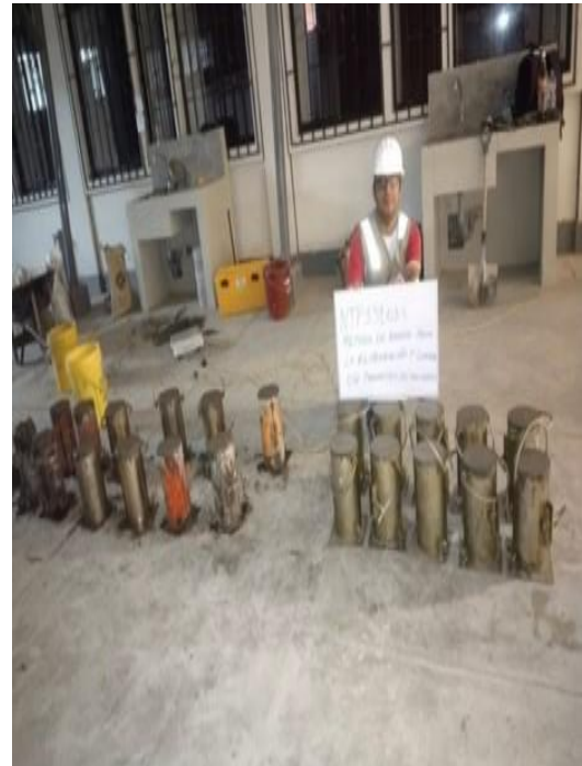
Figura 66 Probetas de concreto elaborados a temperatura ambiental promedio baja (22°C)
