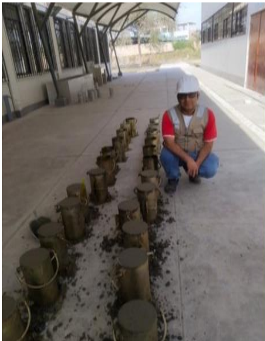
Figura 65 Probetas de concreto elaborados a temperatura ambiental promedio alta (30°C)
