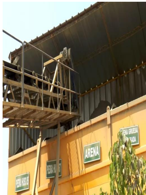
Figura 74 Almacenamiento de agregados en tolvas y bajo sombra para la conservación de sus propiedades
