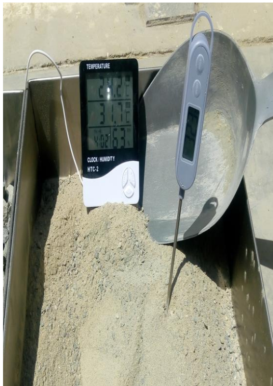
Figura 49 Registro de la temperatura ambiental 31.7°C con el higrómetro
