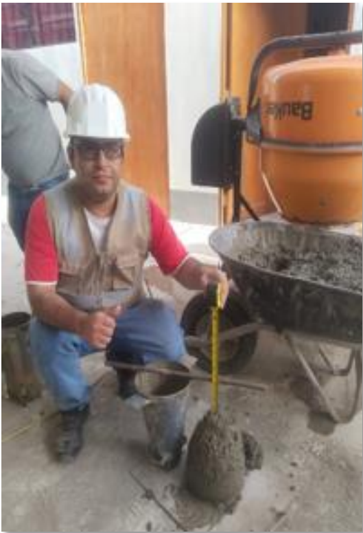
Figura 67 Realización del Ensayo del Slump
