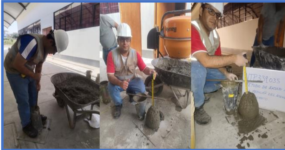
Figura 33 Ensayo de Asentamiento del Concreto
