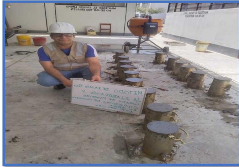
Figura 11 Realización de muestras de concreto a una temperatura promedio (30°C) en horario de 1:00 p.m.
