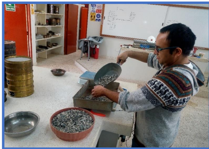
Figura 21 Peso del material en su humedad natural, para luego secarlo en el horno.
