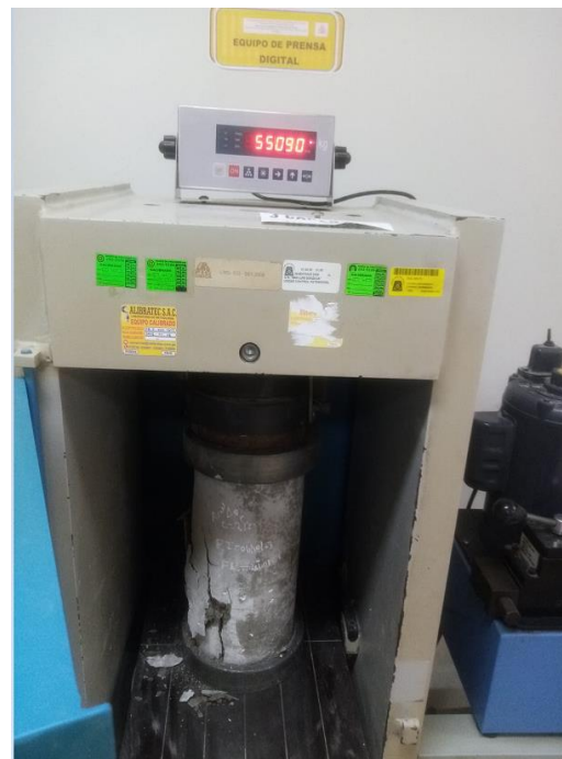
Figura 70 Probetas de concreto elaborados a temperatura ambiental promedio alta (30°C)
