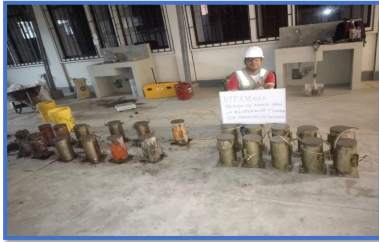
Figura 9 Realización de muestras de concreto a una temperatura baja ( 14^{\circ}\text{C} ) en horario nocturno
