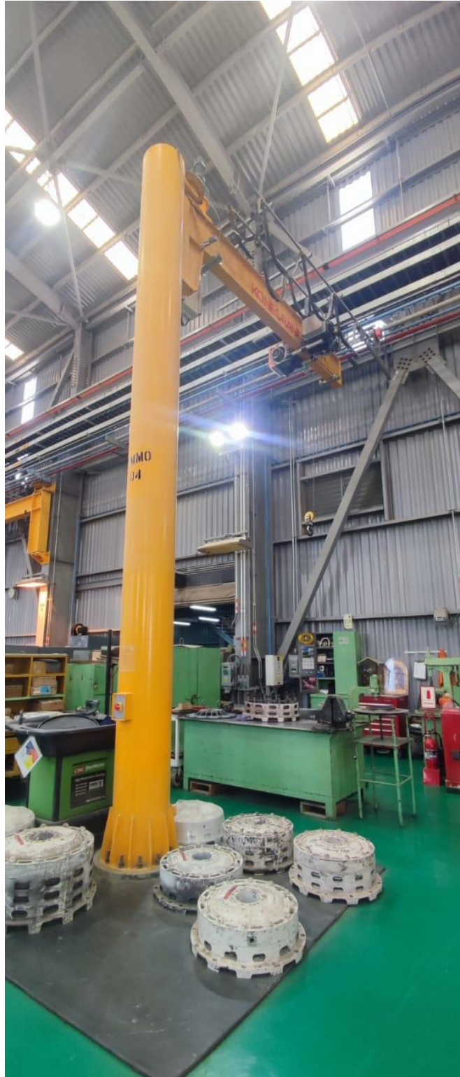
Fig. 5. Grúa pescante en uso por el cliente
