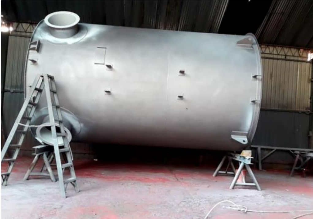
Fig. 6. Tanque de 3.0 m diámetro y 5.0 m de altura
