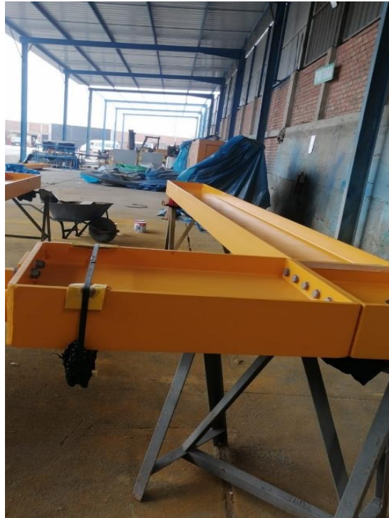
Fig. 21. Fabricación de estructuras metálicas - Grúa pescante
