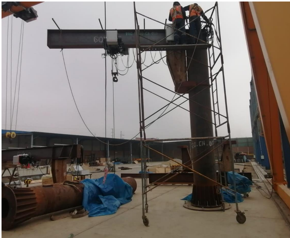
Fig. 9. Fabricación de grúa pescante giratoria 360° de 5 toneladas
