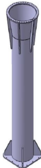
Fig. 14. Columna de grúa pescante
