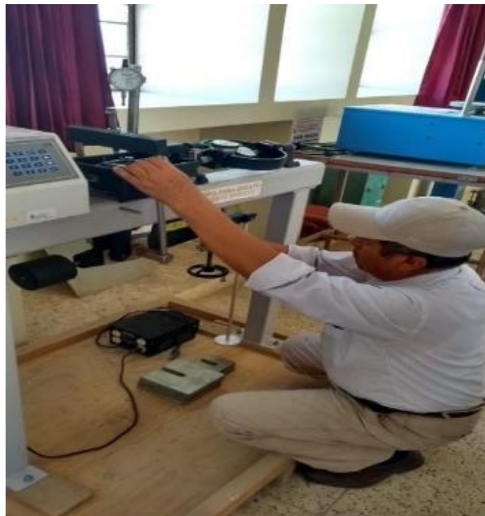
REALIZACIÓN DEL ENSAYO DE CORTE DIRECTO
