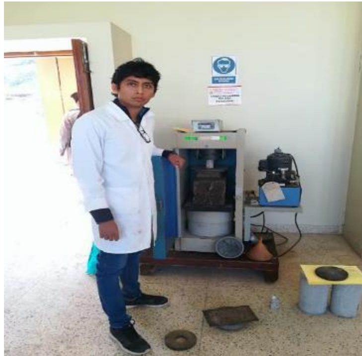
ENSAYO DE COMPRESIÓN DE LOS TESTIGOS DE DIAMANTINA
