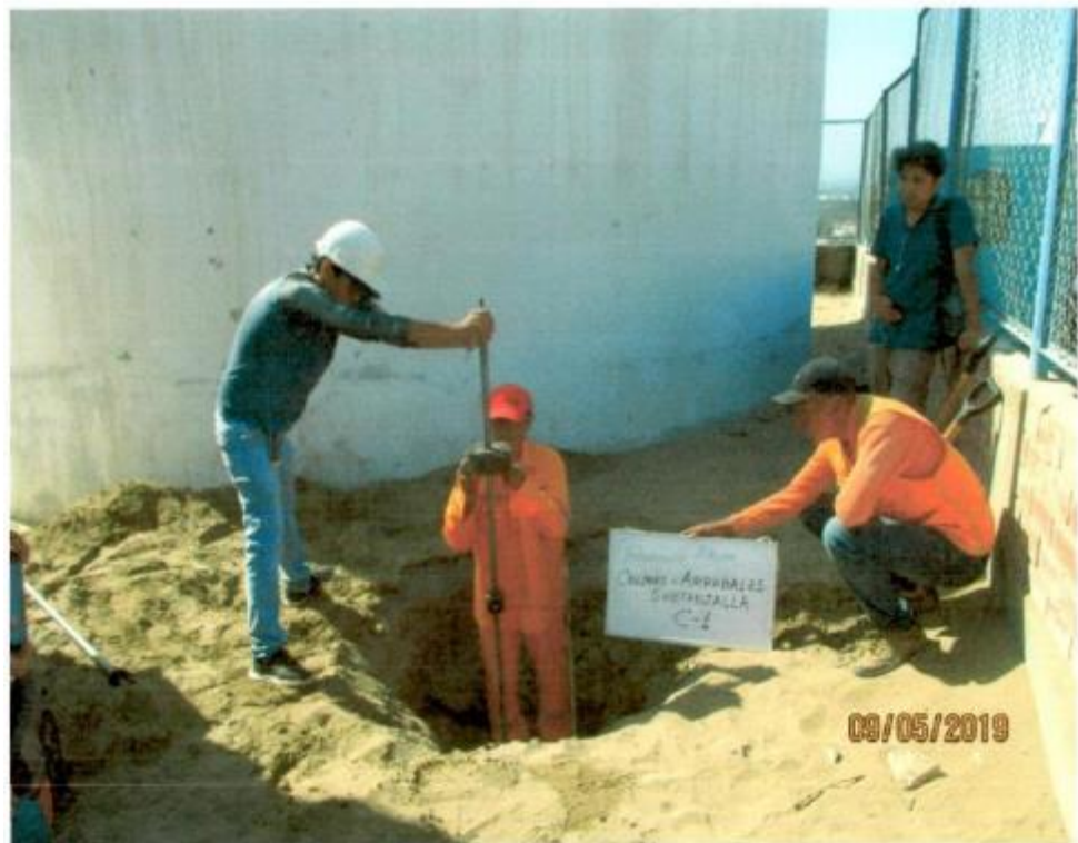
ENSAYO CON PENETROMETRO LIGERO DE PUNTA CÓNICA (SUBTANJALLA- COLINA-ARRABALES)
