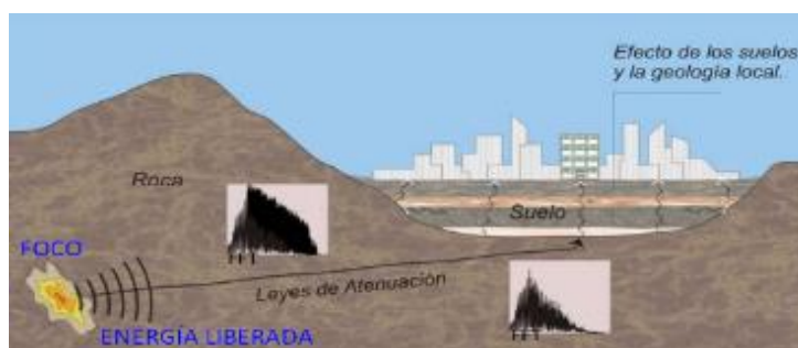
(a) Propagación de energía liberada a través del suelo
