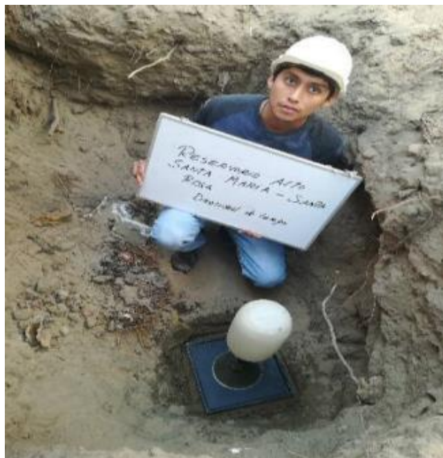
ENSAYO DE CONO DE ARENA (ALTO SANTAMARÍA)
