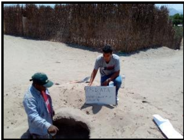
Excavación de la calicata 6
