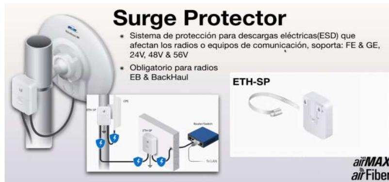
Figura N° 31: Sistema de protección (ESD)
