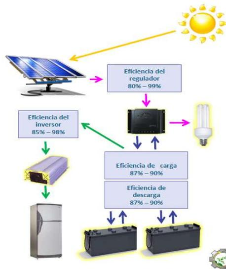
Figura N° 21: Eficiencia del sistema solar
