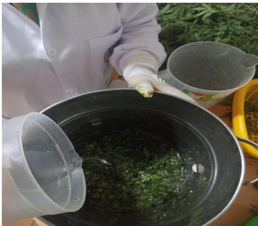
OBTENCION DE ACEITES ESENCIALES POR HIDRODESTILACIÓN MATERIAL FRESCO
