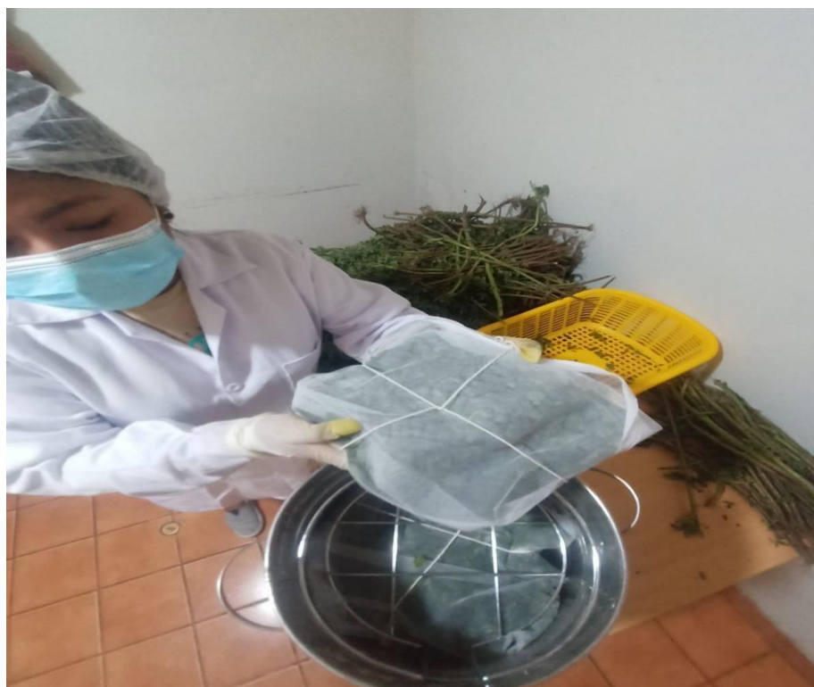
ACONDICIONANDO EL SEGUNDO PAQUETE PARA LA OBTENCION DE ACEITES ESENCIALES POR EL MÉTODO DE ARRASTRES DE VAPOR
