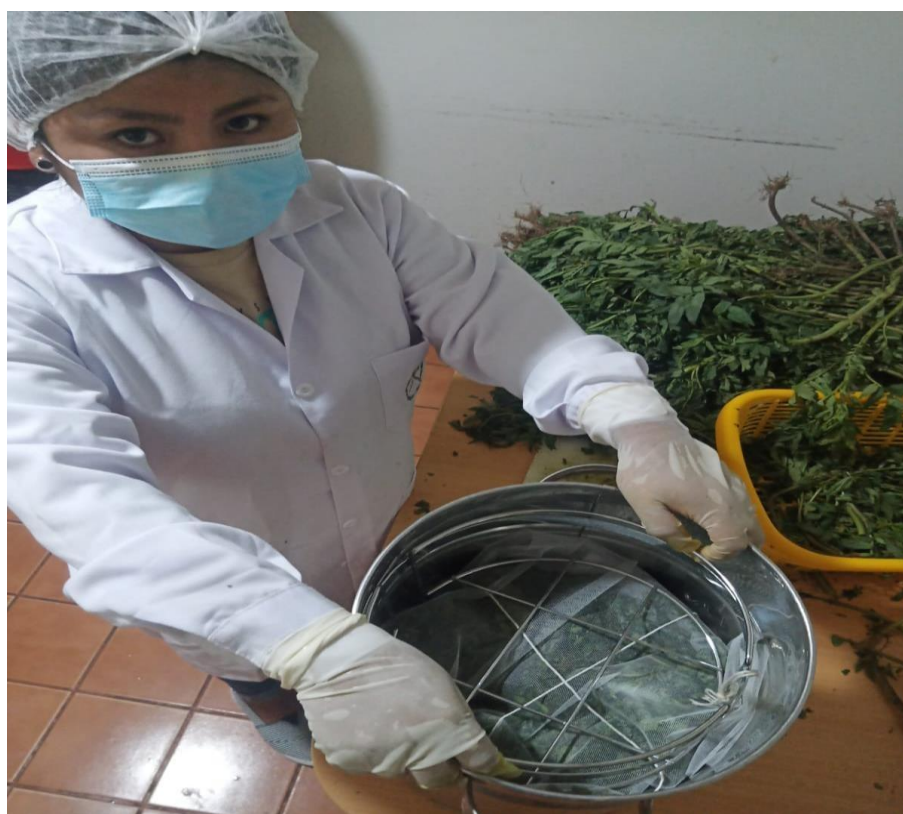
ACONDICIONANDO EL PRIMER PAQUETE PARA LA OBTENCION DE ACEITES ESENCIALES POR EL MÉTODO DE ARRASTRE DE VAPOR
