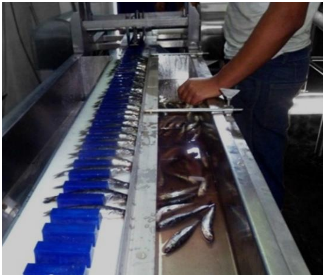
Fig. 3. Fotografía de una máquina decapitadora en la que la sardina es transportada por una faja y luego de ser decapitada pasa por otra faja donde es limpiada por operarias.
