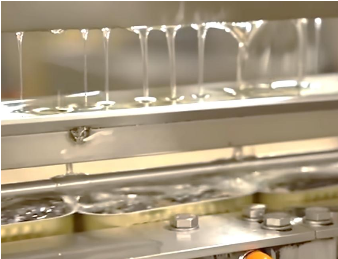
Fig. 8. Adición de líquido de cobertura.
