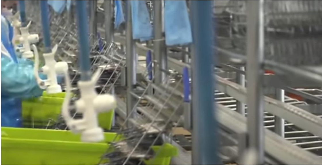
Fig. 4. Fotografía zona de limpieza y lavado de sardinas en una fábrica semiautomática.
