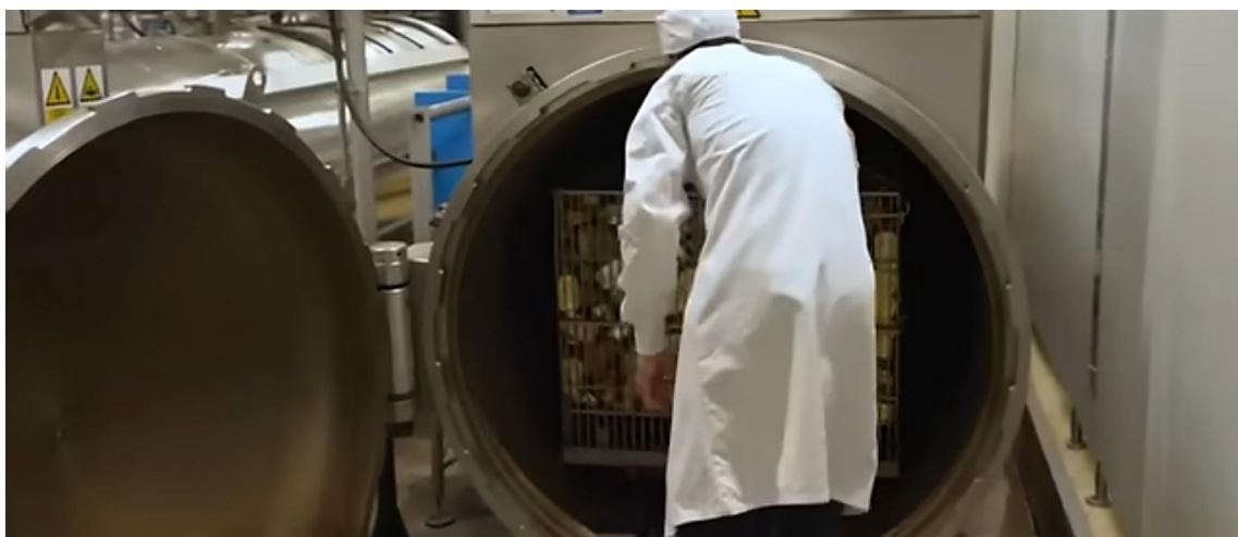
Fig. 10. Autoclave para el proceso de esterilización de las latas de sardina ya selladas previamente.
