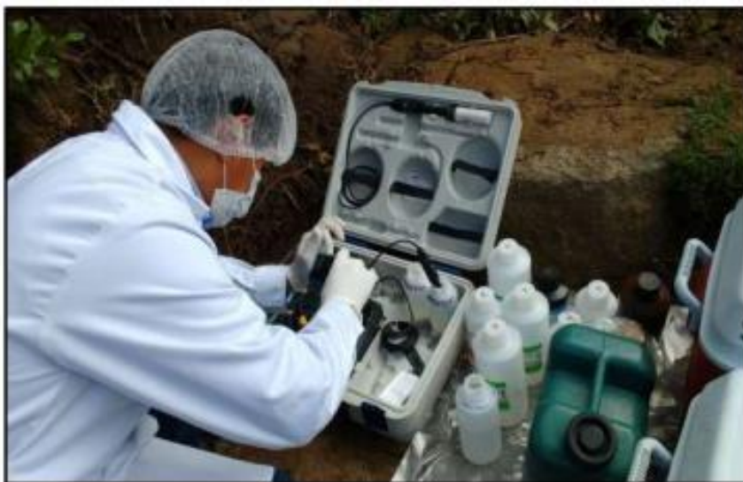
Fig N° 06: Análisis de parámetros en Campo –Multiparametro agua.
