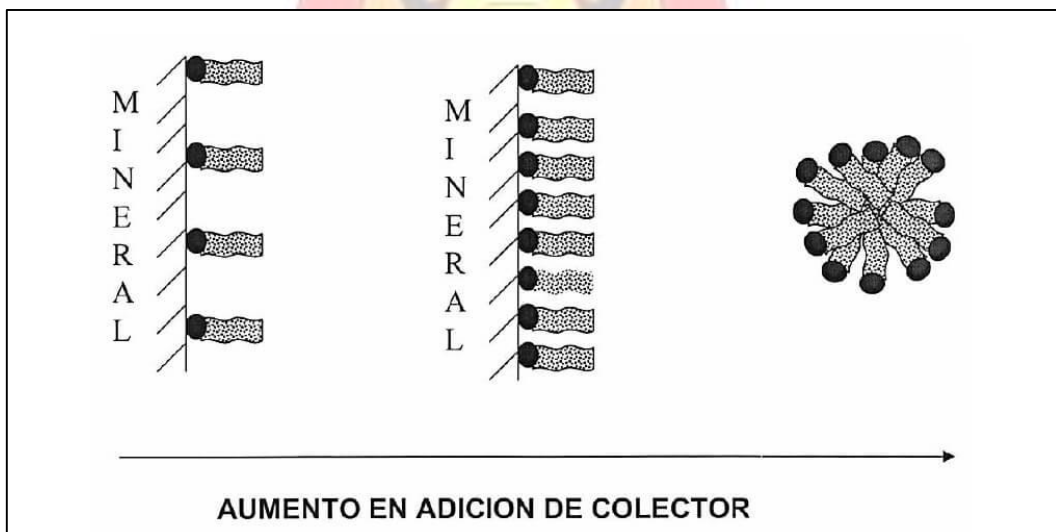
Figura 6. Formación de micelas durante la flotación
