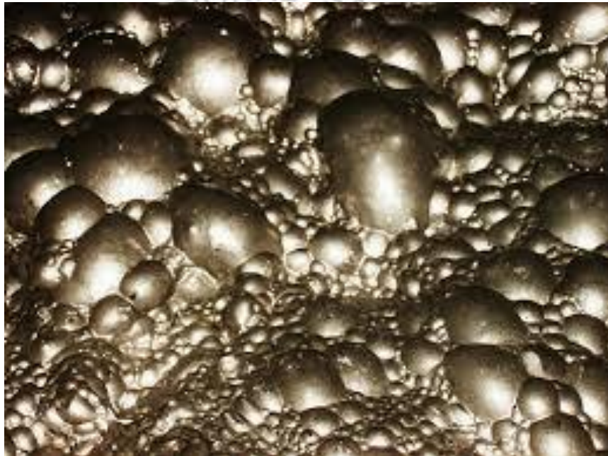
Figura 3. Espuma que se forma en la celda de flotación.
