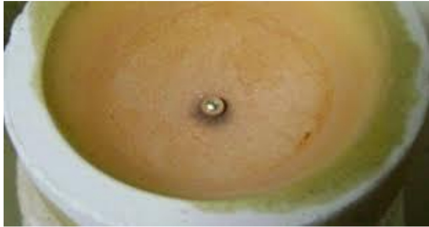
Figura 13. Doré obtenido al final de la copelación.
