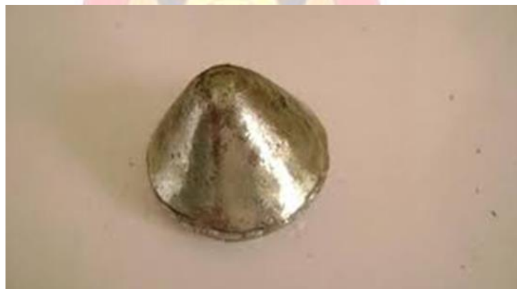
Figura 12. Aleación plomo-oro-plata obtenido de la fusión.
