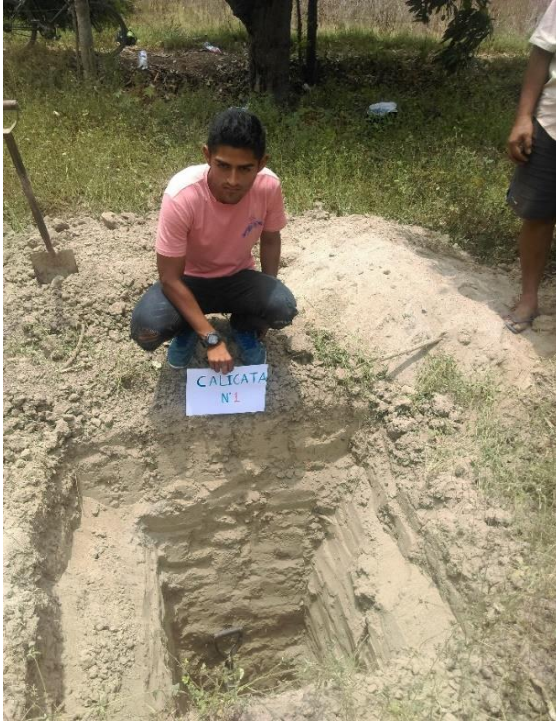
Calicata N°1: se sacaron las muestras y se llevó al laboratorio de la FIC
