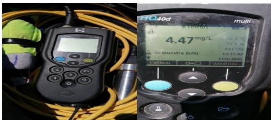
Figura 7: Multiparámetro HACH que mide (oxígeno, saturación y temperatura)
