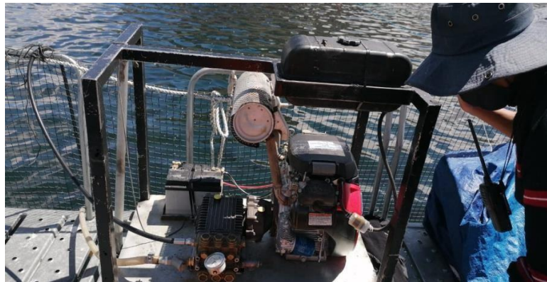
“Hidrolavadora” para lavar las mallas. Foto de la empresa “mar andina s.a.c” pasco (2020)
