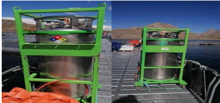
Tanque de oxígeno, se utiliza ante eventos de bajas de oxígeno en el lago, se inyecta mediante mangueras micro porosas en forma de pulpo, “Mar Andino SAC” Cerro de Pasco (2022)
