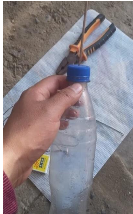
Paso 02. Perforación de la botella y colocación del gancho.
