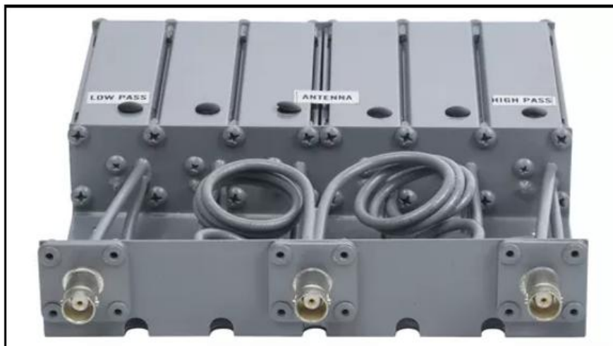
Fig.15 Día 3, duplexer sycom - equipo a calibrar
