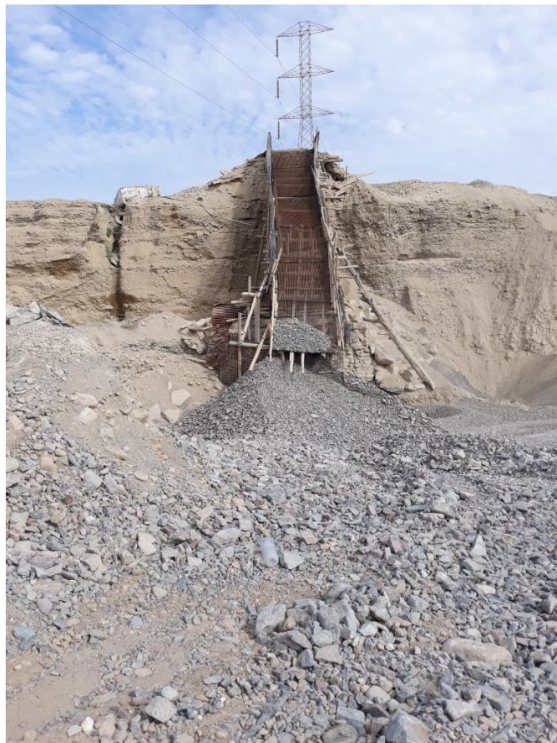
Fig. 3.0. Zaranda con la que se clasifica el agregado
