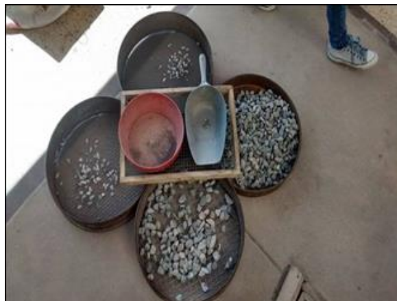
Fig. 5.4. Ensayo de granulometría del agregado
